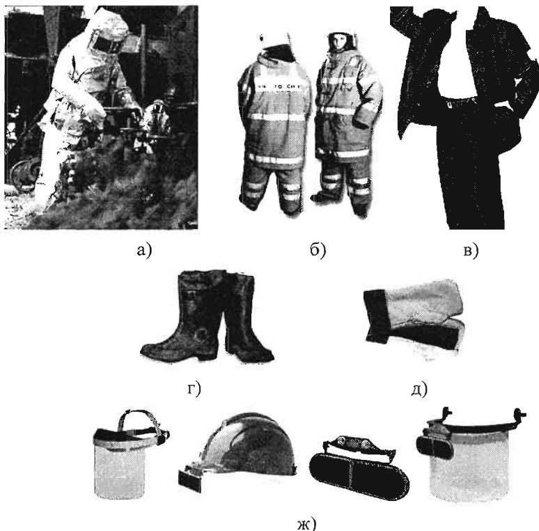
Рис. 7.18. Средства индивидуальной защиты от инфракрасного излучения: а) комплект теплоотражательный для пожарных, он относится к полутяжелому типу и предназначен для защиты пожарного от повышенных тепловых воздействий; б) костюм спасателя МЧС огнестойкий; в) костюм жаростойкий из хлопчатобумажной ткани с огнезащитной пропиткой; г) сапоги резиновые, формовые термостойкие; д) вачеги металлурга, предназначены для защиты рук при контакте с нагретыми поверхностями, от искр и брызг расплавленного металла изготовлены из шинельного сукна и кожевенного спилка; ж) средства защиты лица и глаз
