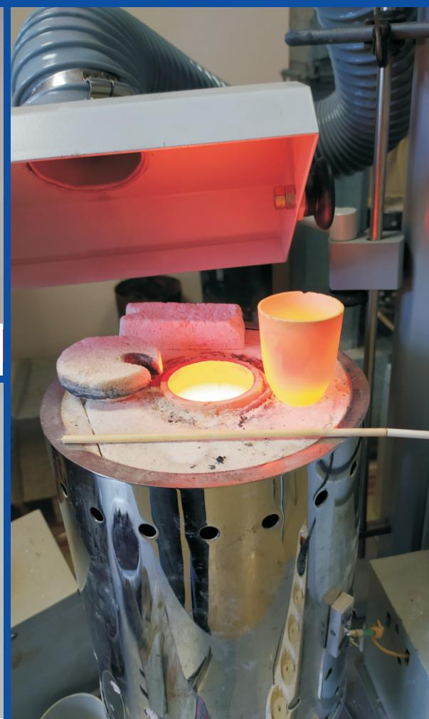
Рис. 3. Печь для выращивания монокристаллов
