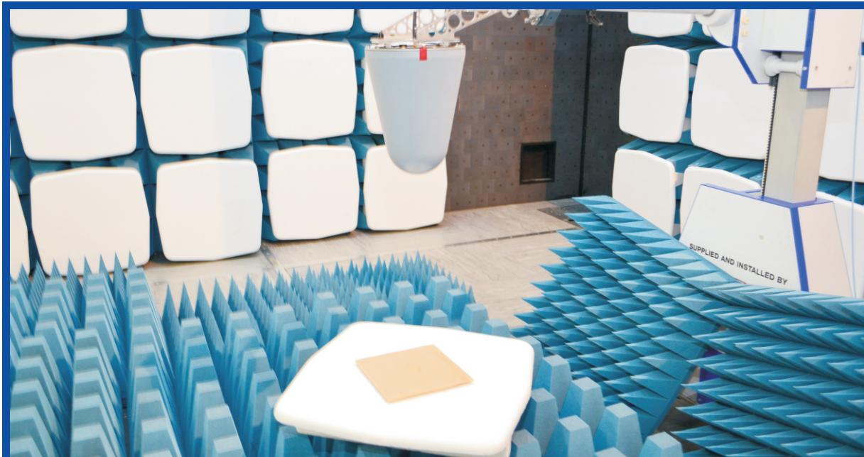
Измерение коэффициента отражения в безэховой камере
