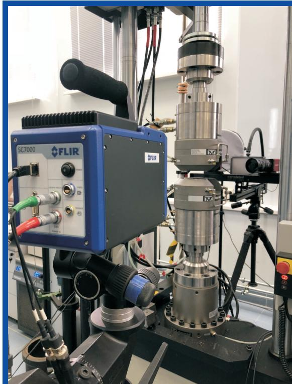
Испытания образцов композитных материалов на саморазогрев при высокочастотном циклическом растяжении
