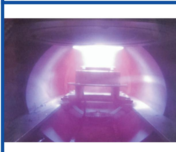
Фотография рабочей камеры установки РИТМ-М в процессе создания покрытия на этапе магнетронного напыления
