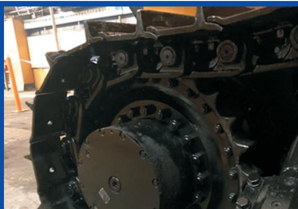
Рис. 1. Опытный образец механизма поворота бесступенчатого дифференциального со следящей системой управления КАТ-010.00.00.000 – 01
