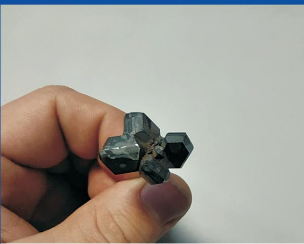
Рис. 2. Сросток 5 монокристаллов  $\text{BaFe}(12-x)\text{Ti}(x)\text{O}19$
