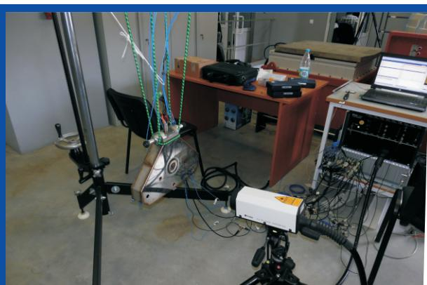
Измерение экспериментальных передаточных функций
