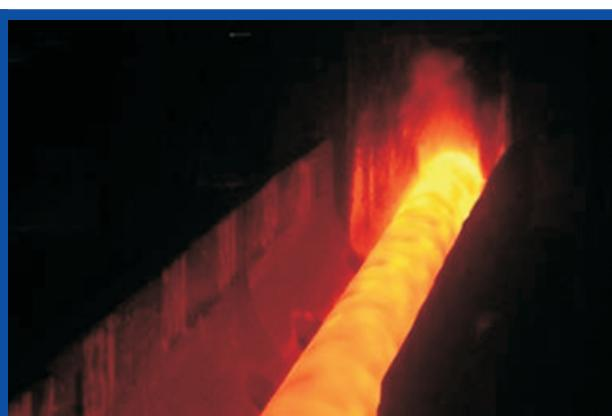
Термическая обработка труб из стали 15Х13Н2
