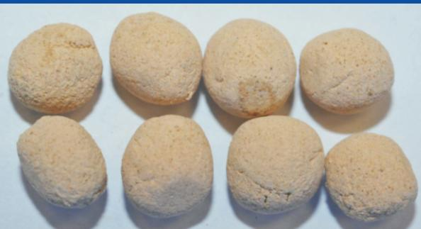
Внешний вид гранул комплексного минерализатора
