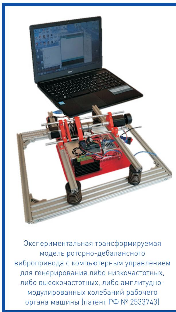
Экспериментальная трансформируемая модель роторно-дебалансного вибропривода с компьютерным управлением для генерирования либо низкочастотных, либо высокочастотных, либо амплитудно-модулированных колебаний рабочего органа машины (патент РФ № 2533743)
