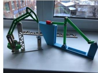
Создание прототипов кривошипно-рычажных механизмов
