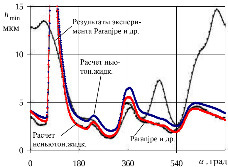
Рис. 6. Минимальная толщина смазочного слоя в коренном подшипнике в зависимости от угла поворота коленчатого вала двигателя V6 GM
