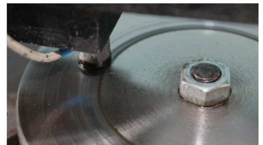
Рисунок 3.15 – Зона контакта пары трения «диск-палец»
