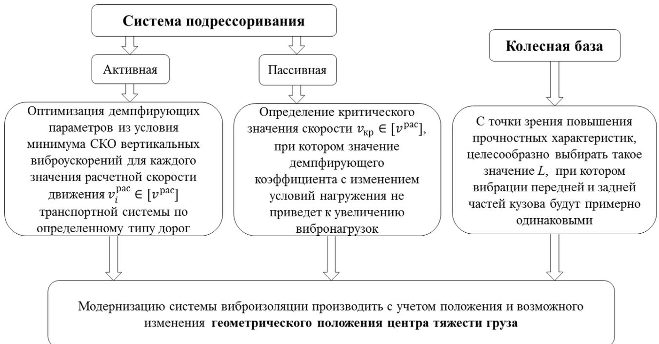
Рисунок 3.11. Направления совершенствования динамических параметров системы виброизоляции
