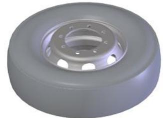
Рисунок 4.11. Трехмерная модель запасного колеса
