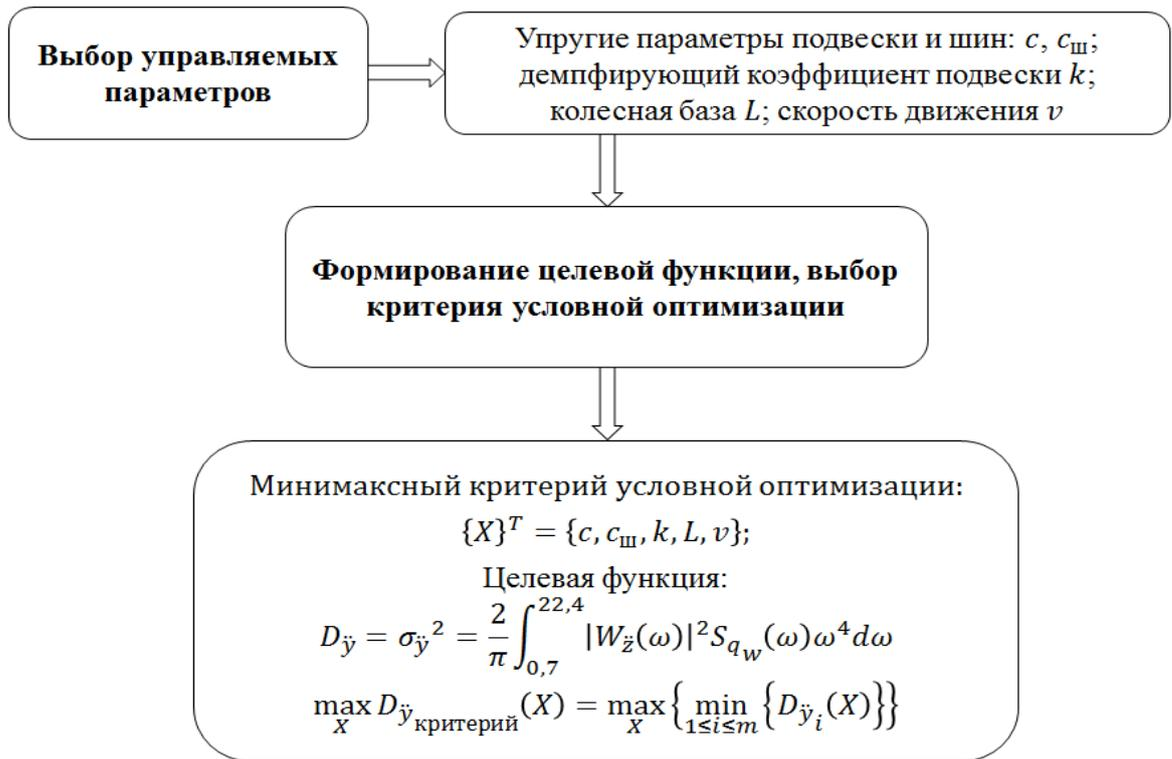
Рисунок 3.2. Постановка задачи оптимизации, выбор управляемых параметров и формирование целевой функции
