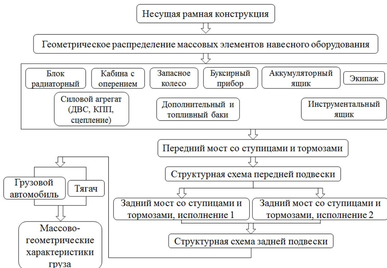
Рисунок 3.6. Схема формирования различных вариантов исполнения грузового автомобиля
