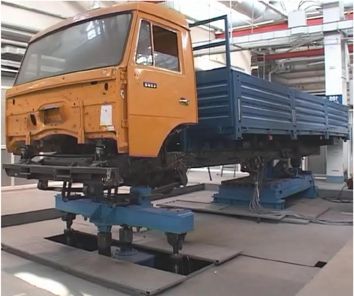
Рисунок 4.1. Испытательный стенд для исследования динамики конструкции транспортной системы
