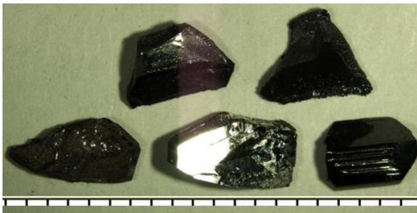
Рисунок 63 – Частично замещенные алюминием монокристаллы гексаферрита бария (шкала мм).
