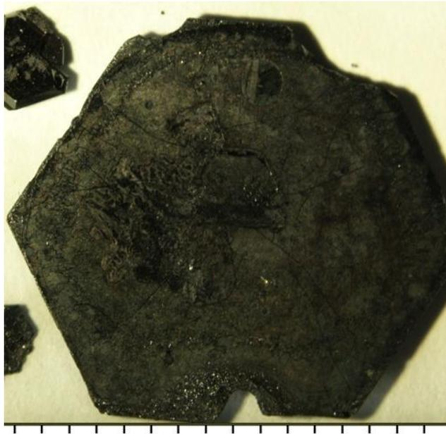
Рисунок 90 – Фотография полученных частично замещенных никелем монокристаллов гексаферрита бария (шкала - мм)
