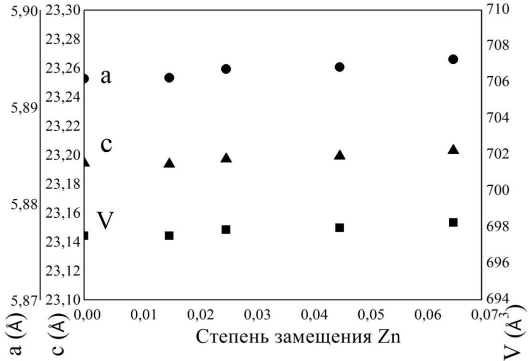
Рисунок 107 – Зависимость параметров решетки  $a$  (Å),  $c$  (Å) и  $V$  (Å<sup>3</sup>) монокристаллов  $\text{BaFe}_{12-x}\text{Zn}_x\text{O}_{19}$  от степени замещения  $x$ .
