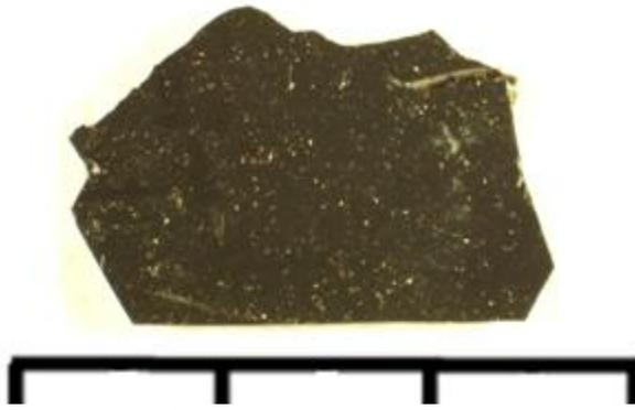
Рисунок 117 – Фотография пластины феррита  $Pb_{0,8}Ba_{0,2}Fe_{10}Al_2O_{19}$
