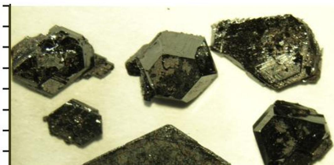
Рисунок 86 – Фотография полученных частично замещенных кобальтом монокристаллов гексаферрита бария (шкала - мм)
