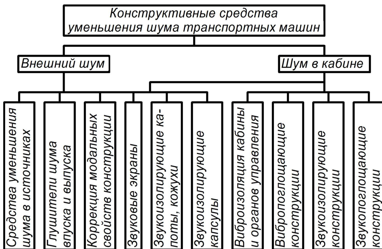
Рисунок 1.1 – Конструктивные средства уменьшения шума транспортных машин
