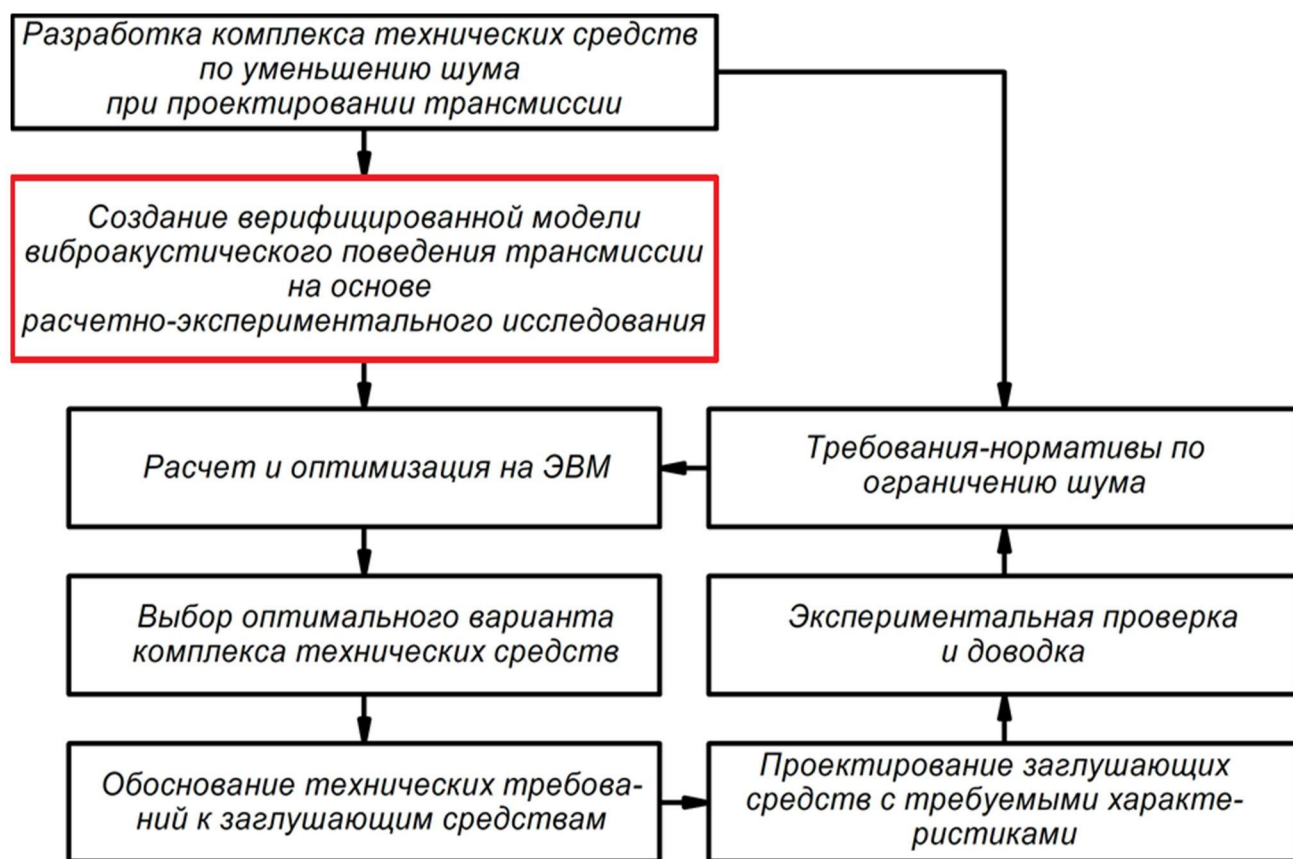
Рисунок 4.44 – Предлагаемая структура решения задачи уменьшения шума транспортной машины при проектировании
