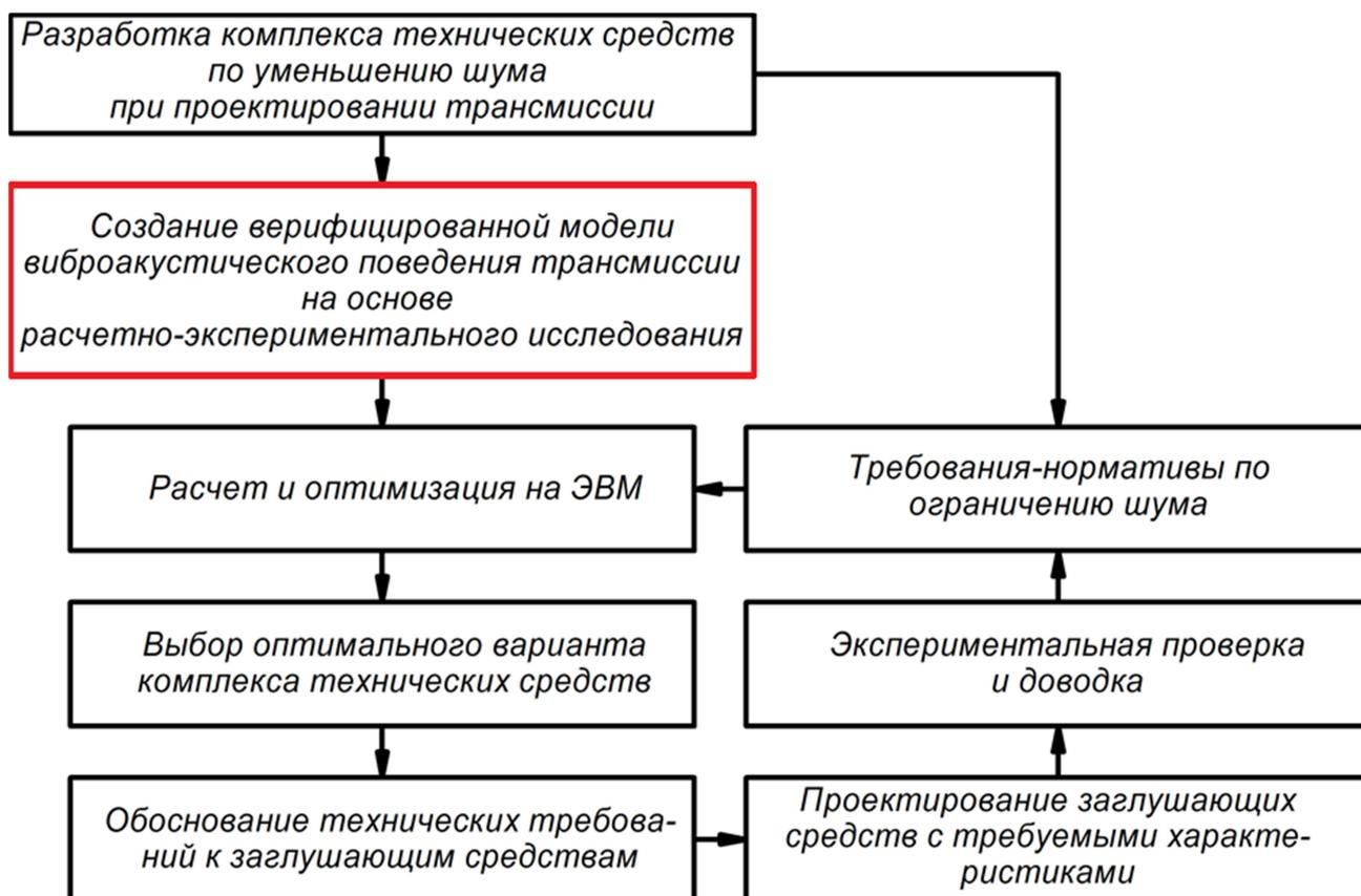
Рисунок 12 – Предлагаемая структура решения задачи уменьшения шума транспортной машины при проектировании
