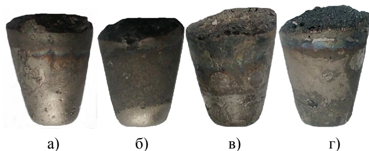
Рис. 4.36. Слитки висмутсодержащих никелевых сплавов с добавками а) празеодима; б) диспрозия; в) неодима; г) эрбия
