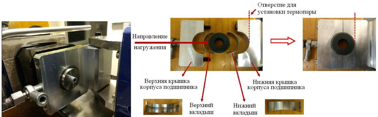
Рисунок 1.36 – Узел трения машины WAZAU UTM-2000
