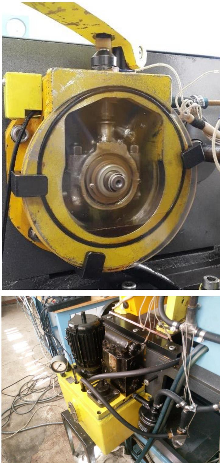
Рисунок П.1.2 – Модельный подшипник скольжения и маслостанция стенда
