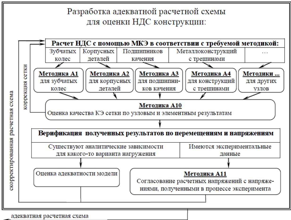
Рисунок 2.1. Алгоритм разработки адекватной расчетной схемы для оценки НДС конструкции
