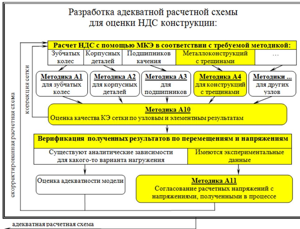
Рисунок 6.22 – Этапы алгоритма разработки адекватной расчетной схемы для оценки нагруженности сварного образца
