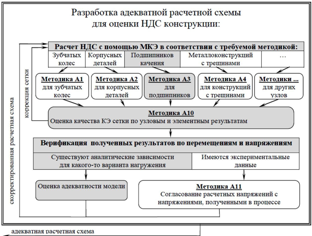
Рисунок 2.7. Алгоритм выбора адекватной расчетной схемы для анализа НДС подшипника качения
