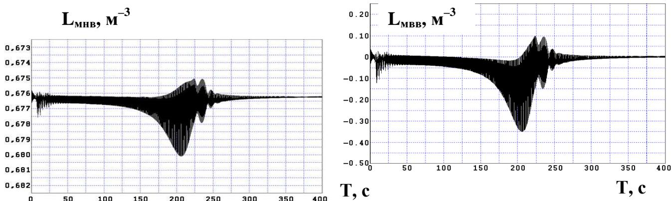
Рис. 13. Смещение  $L_{MNB}$  нижней (слева) и  $L_{MBV}$  верхней (справа) точек мачты в месте крепления соответственно к фундаменту и ступице в вертикальном направлении (мм) в зависимости от времени  $T$  (с)
