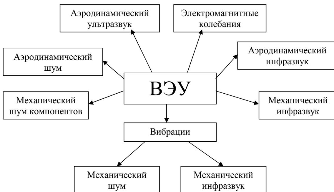
Рис. 2. Параметры работающей ветроэнергетической установки (ВЭУ), негативно влияющие на окружающую среду, здоровье и самочувствие человека
