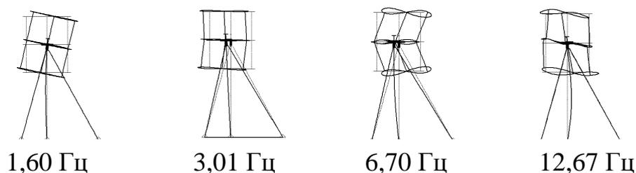
Рис. 8. Формы основных тонов упругих поперечных колебаний ВЭУ
