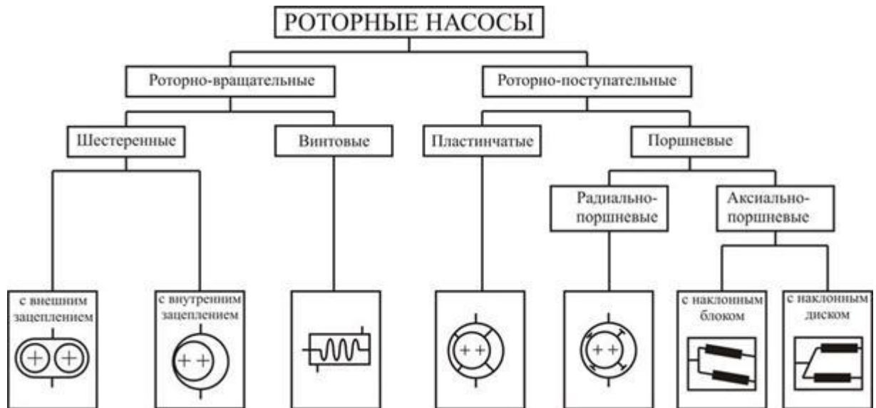
Рис. 2. Классификация роторных насосов [38]
