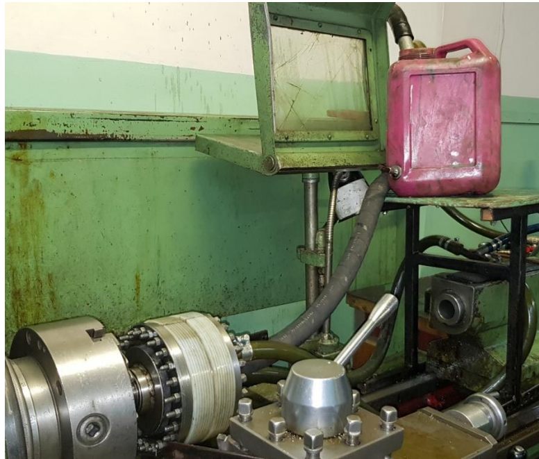
Рис. 100. Испытания двухступенчатой ПРГМ 2×2 в режиме масляного насоса
