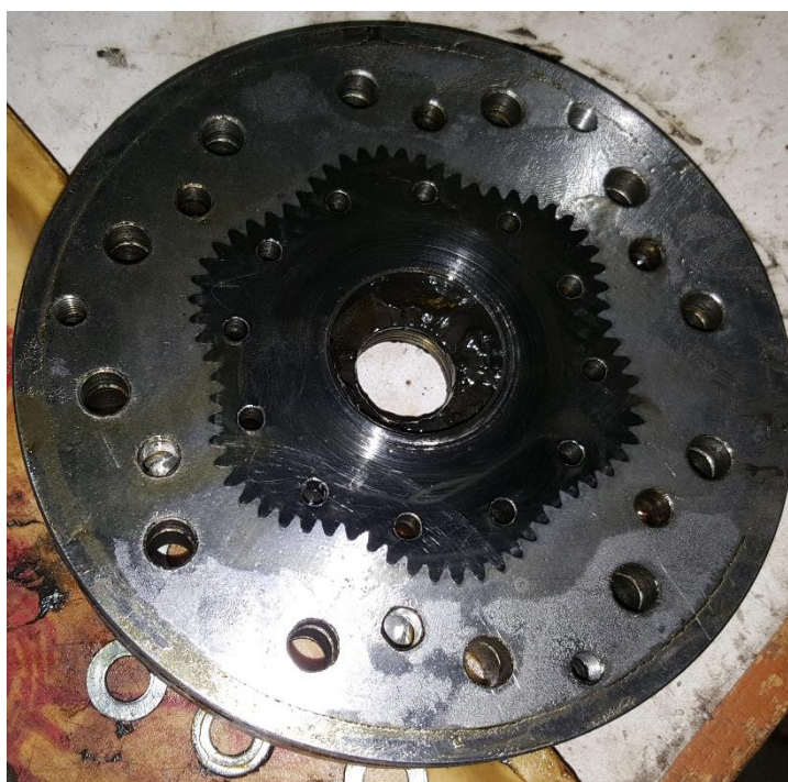
Рис. 89. Демонтаж крышки ПРГМ после работы сателлитов, покрытых баббитом
