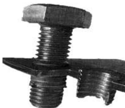
Рис.18. Внешний вид резьбового соединения в тонколистовой заготовке толщиной  $\delta=2,0$  мм, диаметр отверстия  $d=5,0$  мм
