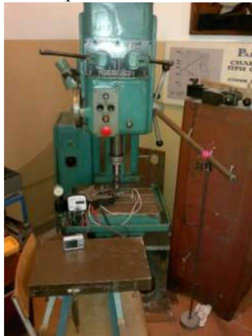
Рис. 1. Экспериментальная установка: 1 – вертикально-сверлильный станок; 2 – патрон; 3 – пуансон; 4 – индикатор часового типа; 5 – динамометр механический; 6 – заготовка (пластина); 7 – цифровой фотоаппарат; 8 – рычаг для установки груза; 9 – милливольтметр МПП-254; 10 – хромель-алюмелевая термопара; 11 – груз
