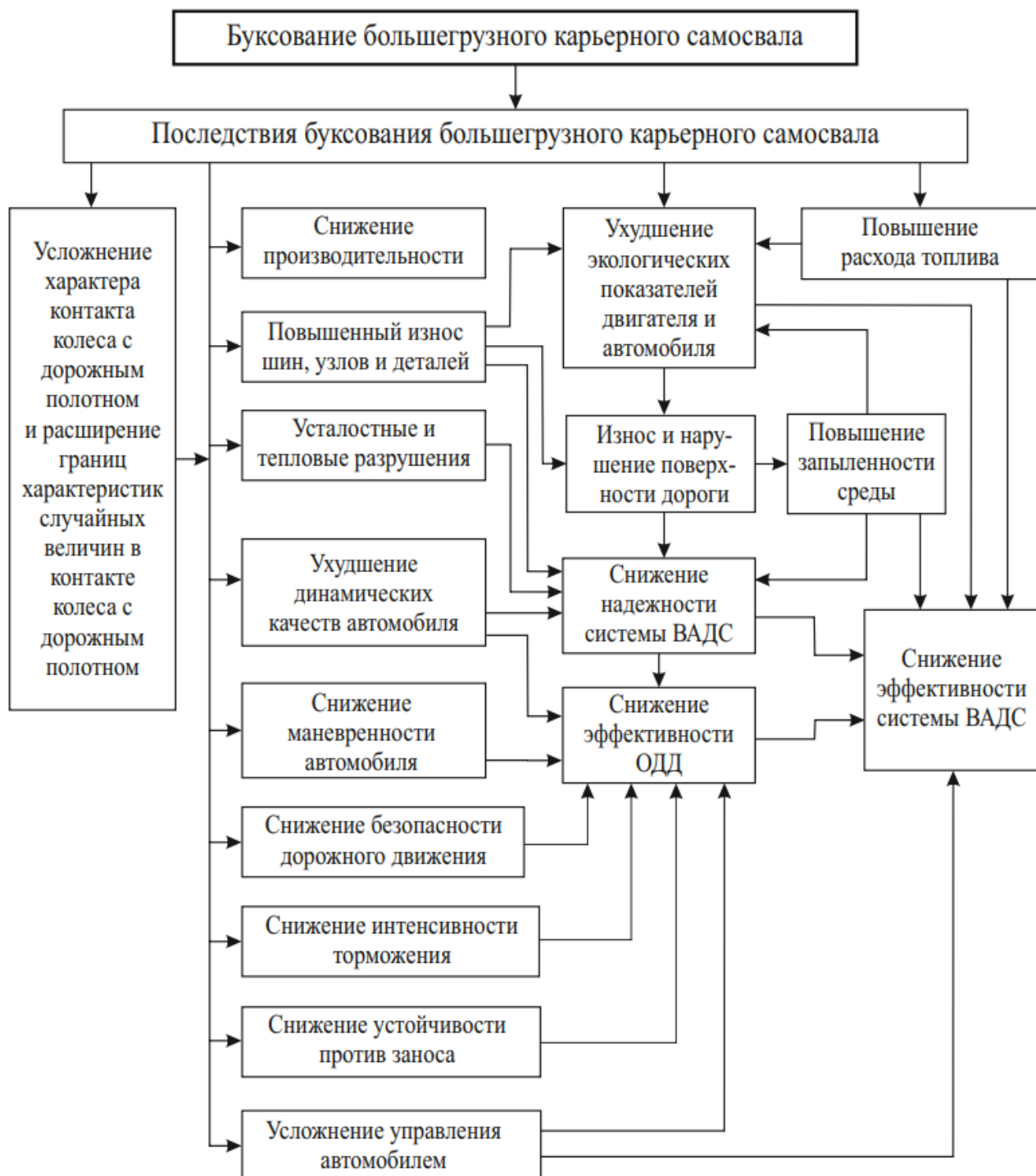
Рисунок 2.12 – Схема причинно-следственной связи между буксованием колеса автомобиля и ухудшением ее эффективности использования
