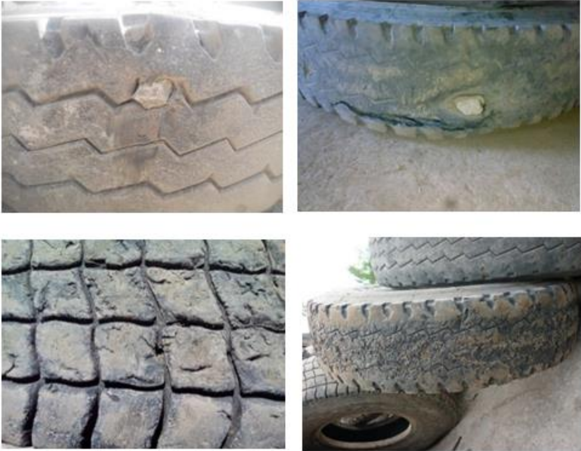
Рисунок 2.3 – Механические повреждения автомобильной шины на горной карьерной дороге, засоренной дресвяными и щебенистыми обломками горных пород
