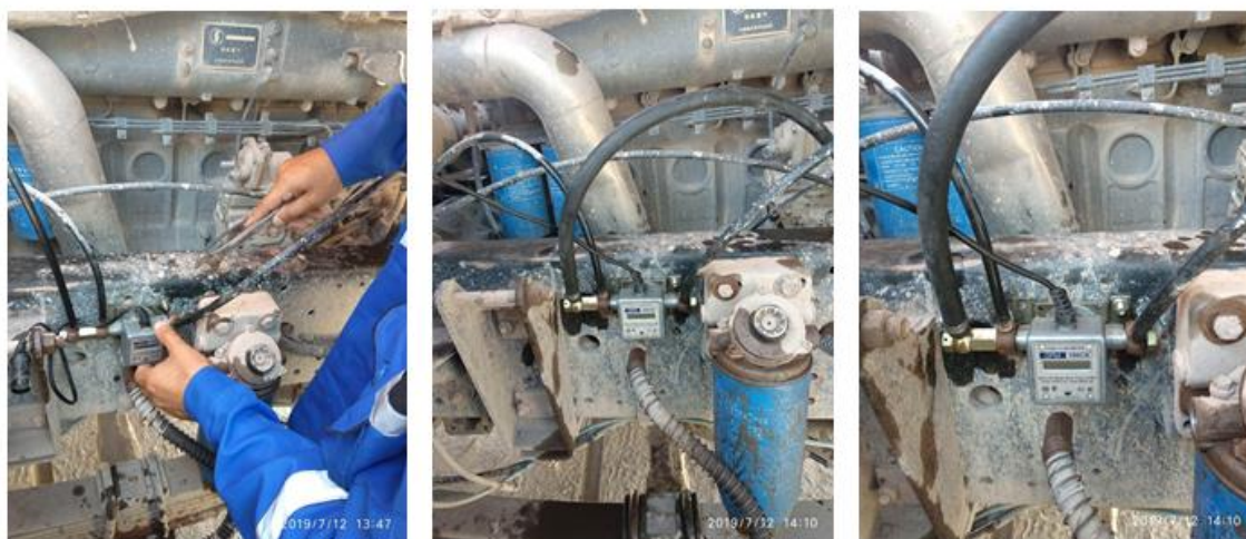
Рисунок 3.6 – Подключение расходомера топлива DFM в топливную систему автомобиля SHACMAN-SX3256DR384
