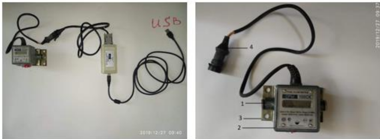
Рисунок 3.11 – Расходомер топлива DFM: 1 – измерительная камера кольцевого типа; 2 – верхняя крышка с находящейся внутри микропроцессорной платой; 3 – кронштейн; 4 – интерфейсный кабель с разъемом подключения.
