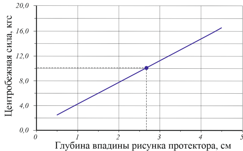
Рисунок 2.13 – Зависимость величины центробежной силы P_u от глубины впадины h_e для автомобиля БелАЗ-7540В
