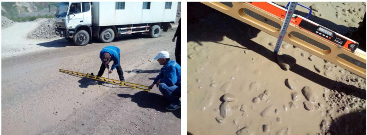
Рисунок 3.4 – Измерение неровностей карьерной дороги при помощи универсальной дорожной рейки РДУ-КОНДОР
