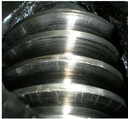
Рисунок 1.1.10 – Поверхностные трещины на витках червяка
