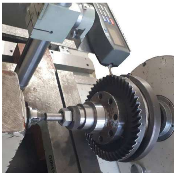
Рисунок 3.3.1 – Схема измерения шероховатости на боковой поверхности зуба спироидного колеса
