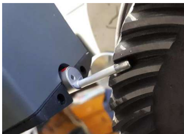
Рисунок 3.3.2 – Положение пера датчика «Измерителя шероховатости TR200» во впадине колеса
