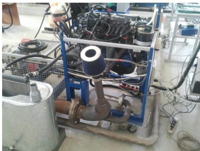
Рисунок 9 – Общий вид стенда с установленным эжектором
