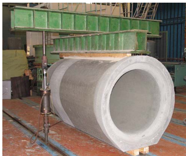
Рис. 5. Испытания безнапорной железобетонной трубы по ГОСТ 6482–88
