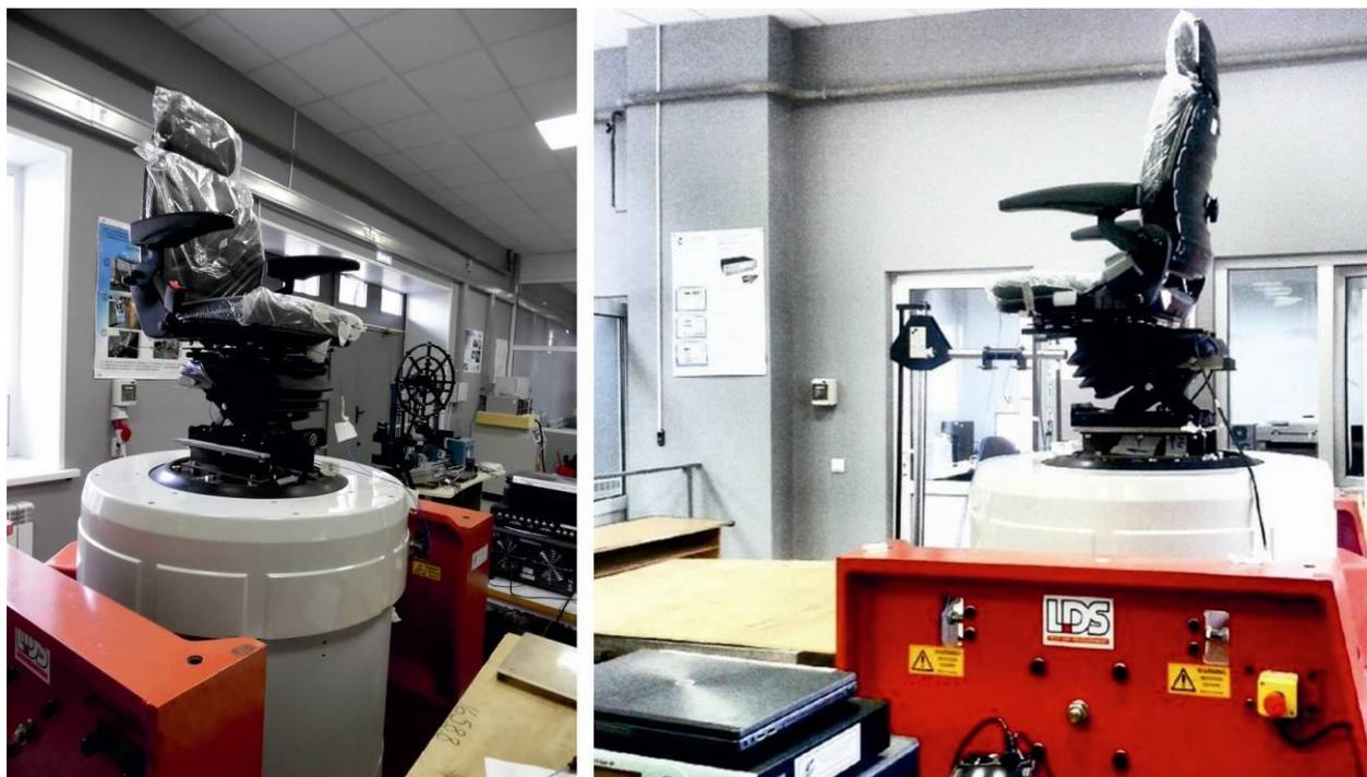
Рисунок 3.2 – Установка кресла на испытательном стенде
