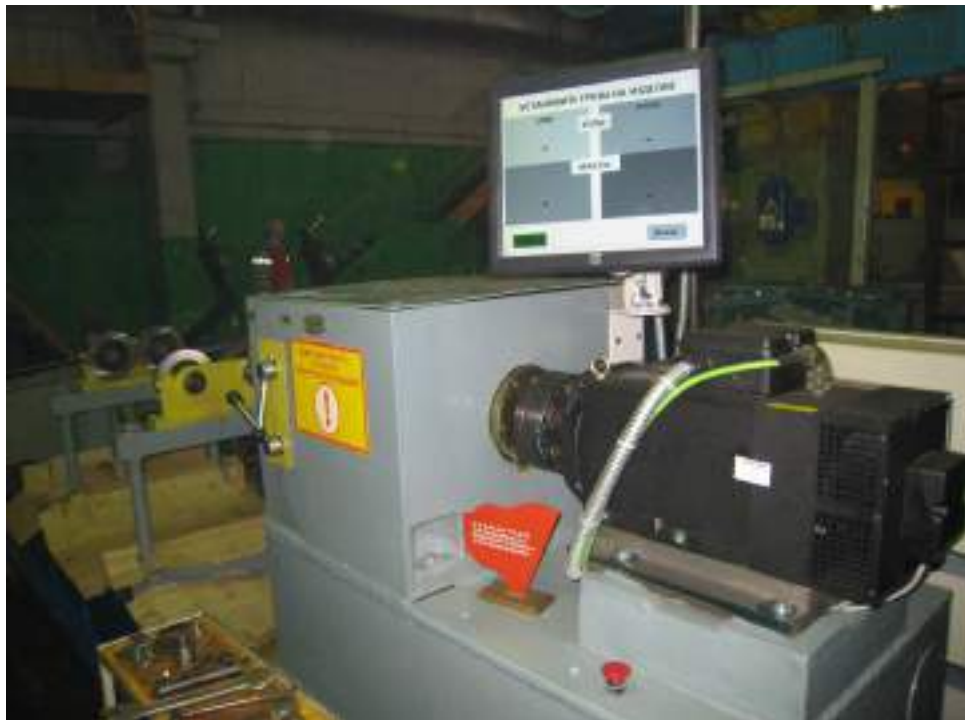
Рисунок 6.3 – Модернизированный балансировочный станок МС-9535 (инв. № 81310 в МСК-1 ОАО «КЗ «Ростсельмаш»)
