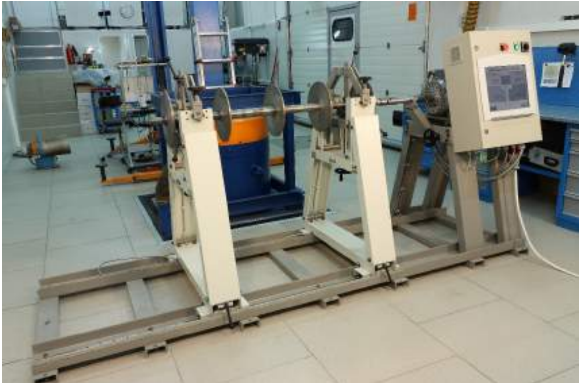
Рисунок 6.5 – Балансировочный станок DBR-300-1800, изготовленный в ДГТУ и установленный в ООО «Новатор-Плюс»
