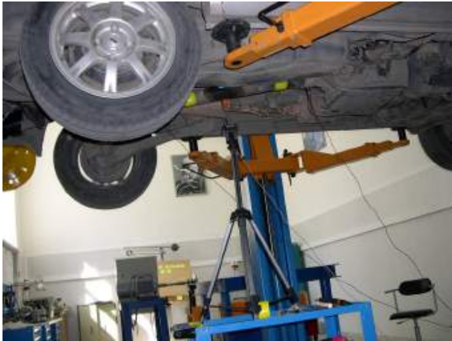
Рисунок 6.8 – Балансировка карданного вала легкового автомобиля на месте
