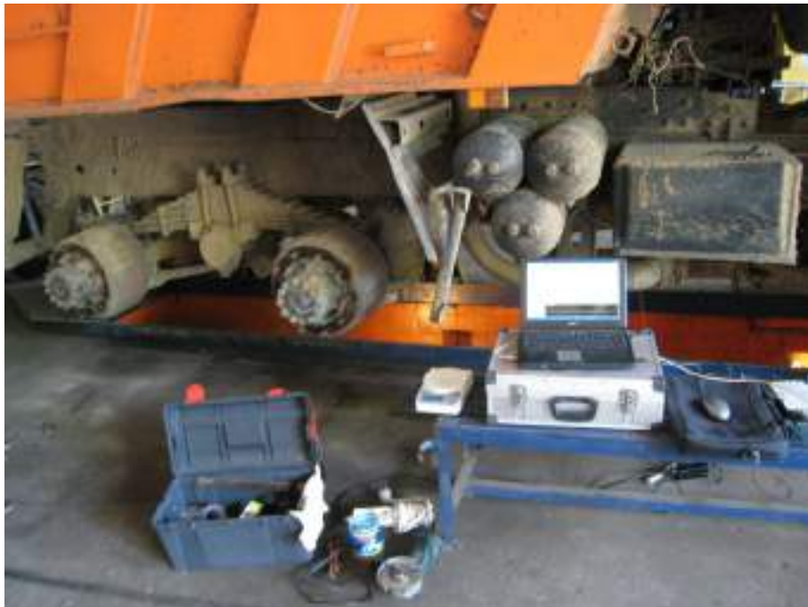
Рисунок 6.9 – Балансировка карданного вала грузового автомобиля на месте
