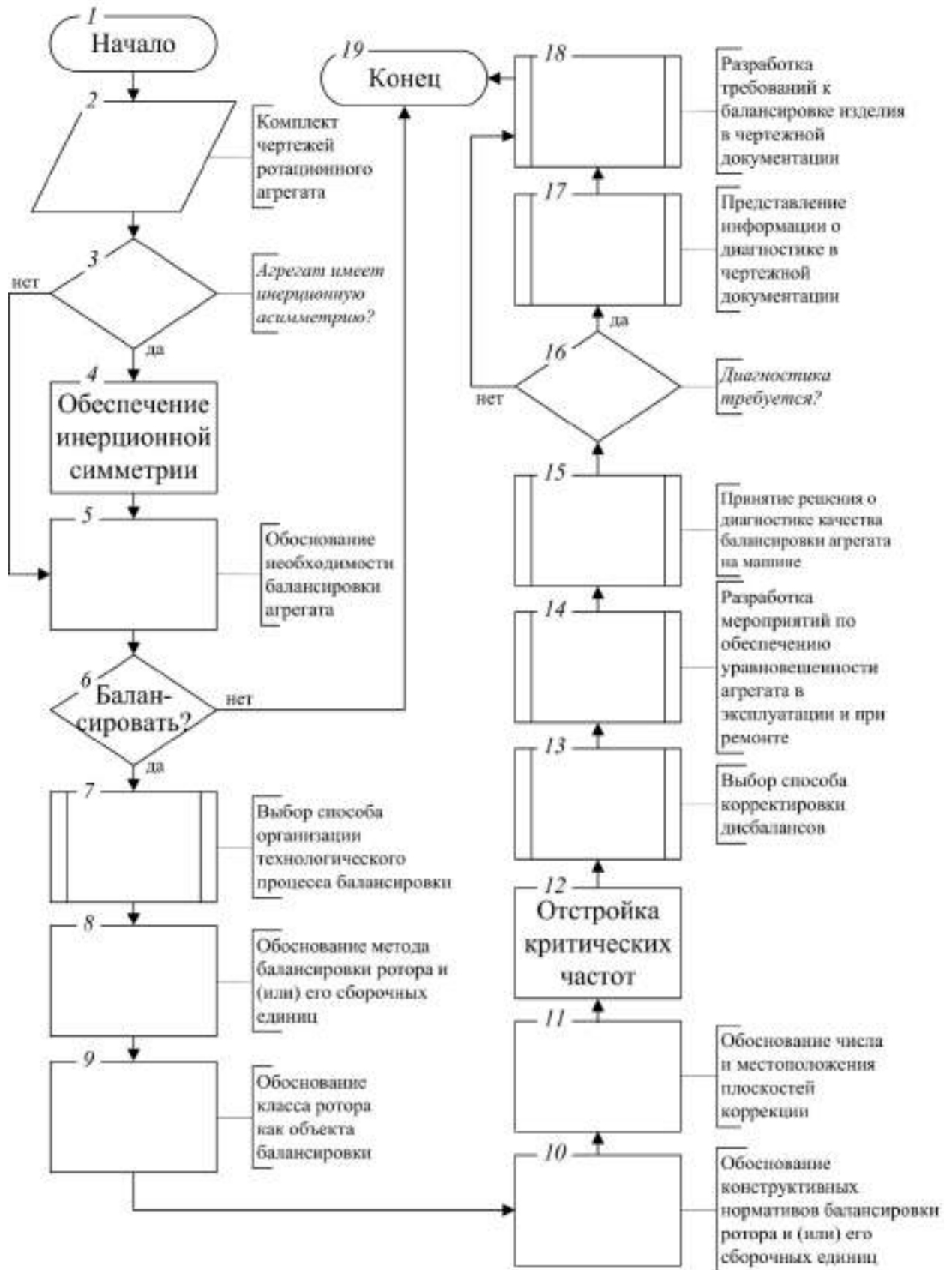
Рисунок 1.2 – Обобщенный алгоритм проектирования уравновешенной конструкции ротационного агрегата машины
