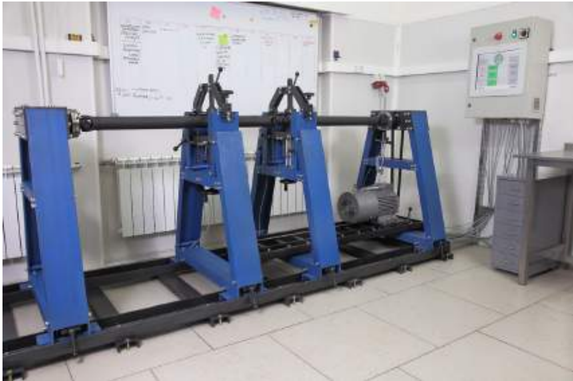
Рисунок 6.4. Балансировочный станок DBR-4-400-3800, установленный в научной лаборатории кафедры ТММ ДГТУ
