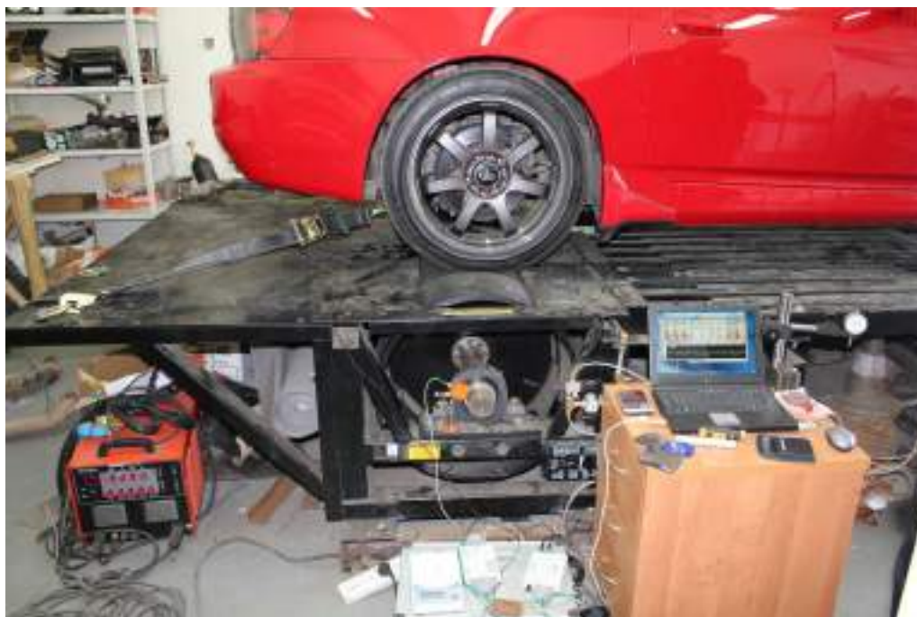
Рисунок 6.10 – Балансировка бегового барабана стенда измерения мощности DYNOCOMDC-Tuner
