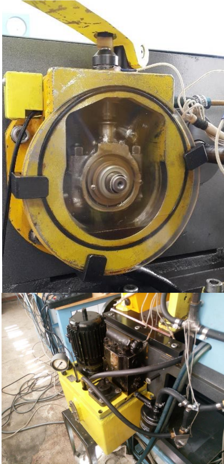
Рисунок П.1.3 – Модельный подшипник скольжения и маслостанция стенда
