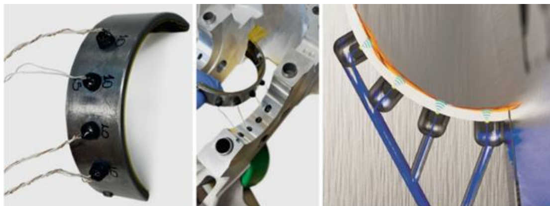
Рисунок 1.9 – Комплект датчиков, установленных на обратной стороне вкладыша
