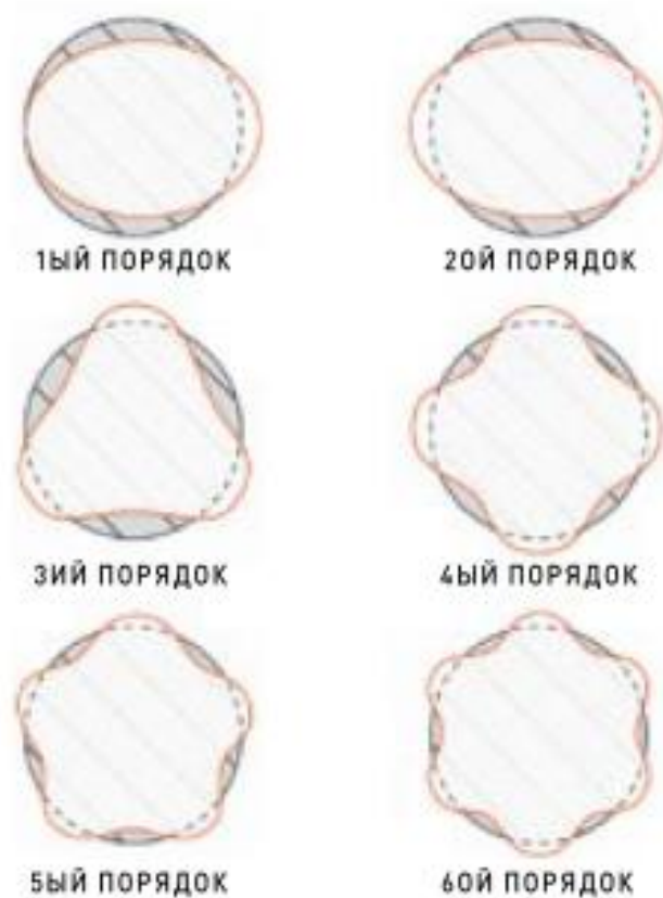
Рисунок 1.2 – Типичные отклонения формы шеек коленчатого вала от правильной круглой формы
