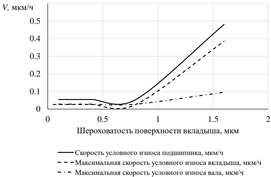
Рисунок 4.33 – Скорость изнашивания элементов подшипника в зависимости от шероховатости поверхности вкладыша
