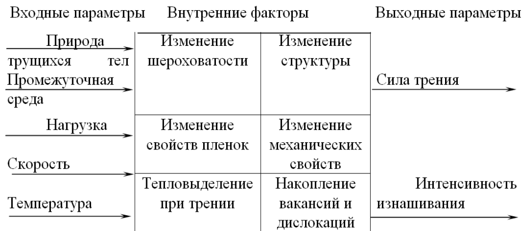
Рисунок 2.1 –Схема факторов, влияющих на фрикционное взаимодействие твердых тел
