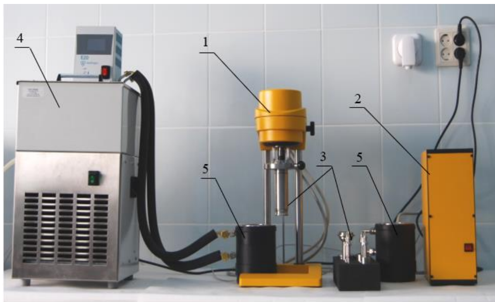
1 – вискозиметр; 2 – блок управления; 3 – измерительные системы; 4 – криостат; 5 – термостатирующие сосуды
