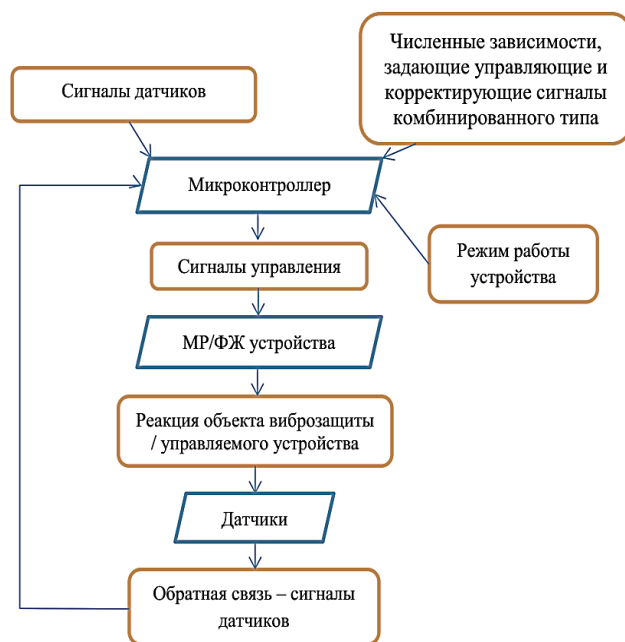
Рисунок 20 – Алгоритм управления МР / ФЖ устройствами
