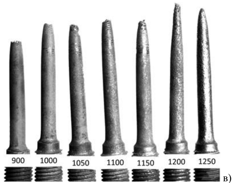
Рисунок 4.8 - Вид разрывных образцов после испытаний на горячее растяжение стали: 12X18H10T (а), 03X18H11(б) и 03X20H9Г3А0,30 (в), \times 2 (цифры на образце означают температуру испытания)
