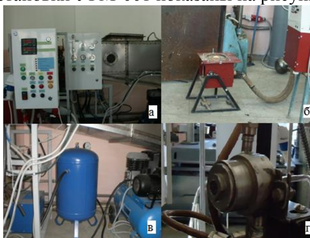
Рисунок 10. Основные технологические узлы установки УРМ-001: а – блок управления, б – плавильная печь, в – компрессор, г – распылительная форсунка
