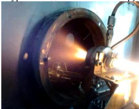
Рисунок 12. Процесс распыления жидкого металла в УРМ-001
