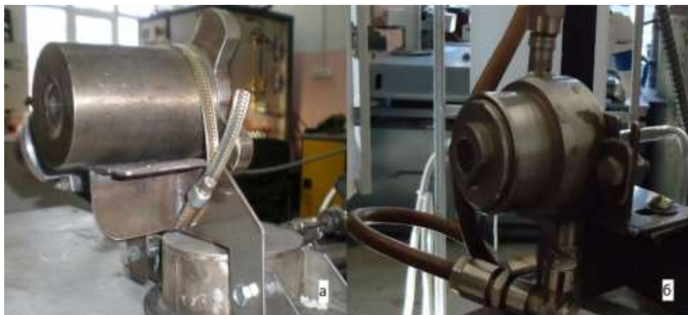
Рисунок 4.15. Фото распылительного узла: а – первый вариант форсунки, б – второй вариант форсунки
