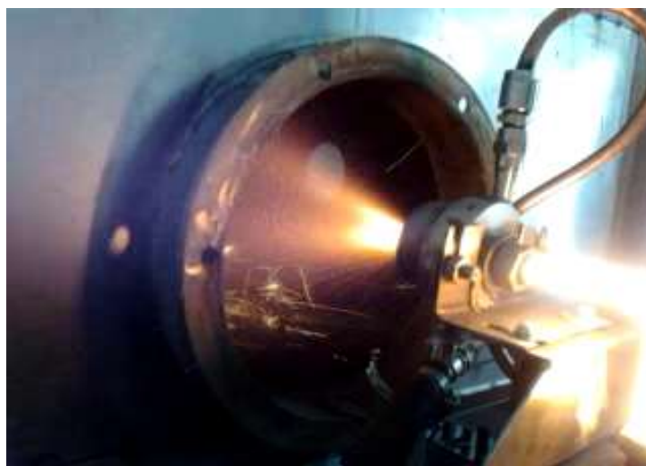
Рисунок 3.5. Процесс распыления жидкого металла в УРМ-001
