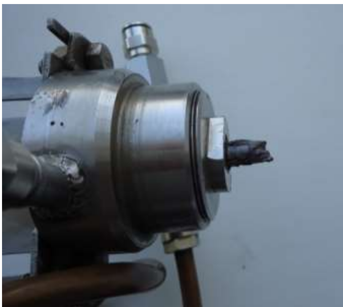
Рисунок 4.11. Застывание канала подачи жидкого металла
