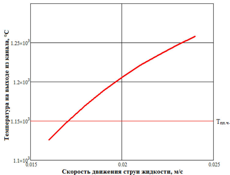
Рисунок 2.4. Зависимость падения температуры жидкого чугуна на выходе из канала подачи от скорости движения
