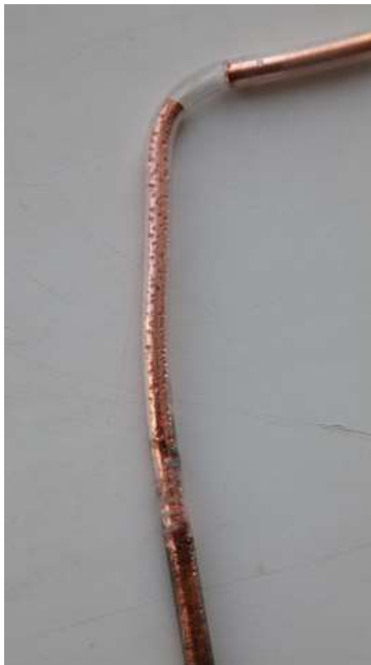
Рисунок 4.7. Застывание меди в кварцевом канале
