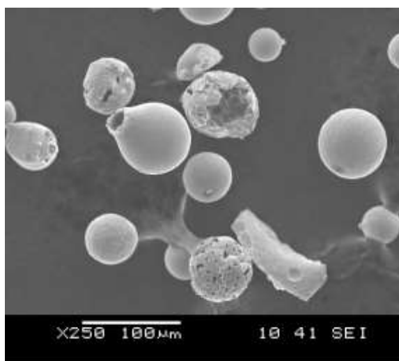
Рисунок 4.26. Фото частиц порошка, полученного при распылении чугуна марки СЧ-15 в струе воздуха
