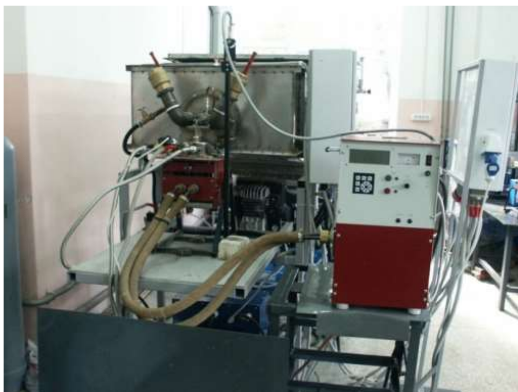
Рисунок 3.3. Установка распыления металла УРМ-001
