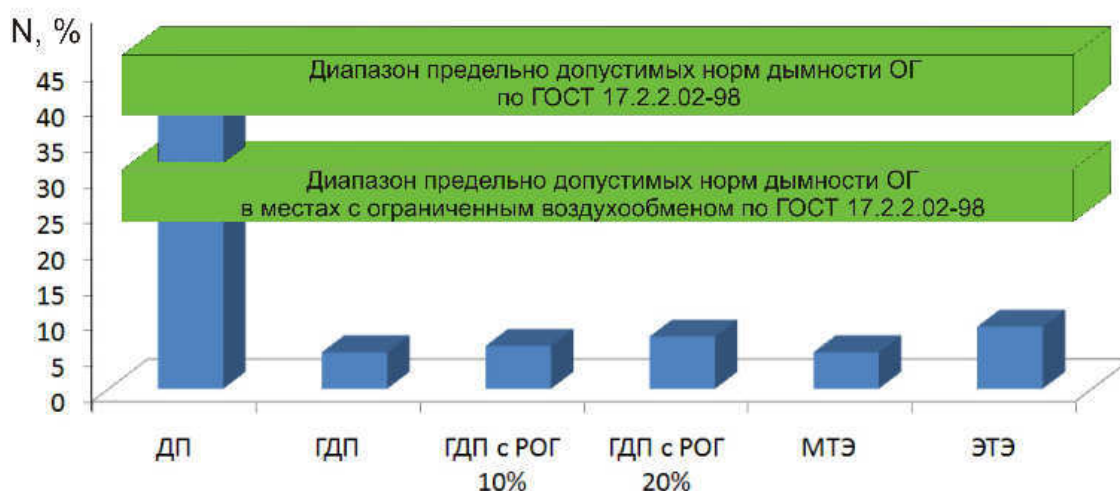
Рисунок 19 – Диаграмма дымности ОГ дизеля 4Ч 11,0/12,5 при работе на ПГ и СТЭ в соответствии с требованиями ГОСТ 17.2.2.02-98
