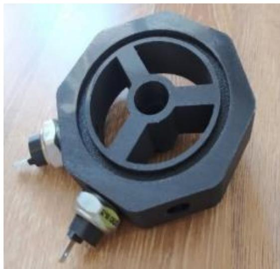
Рисунок 22 – Опытный образец сигнального устройства, изготовленный из полимера
