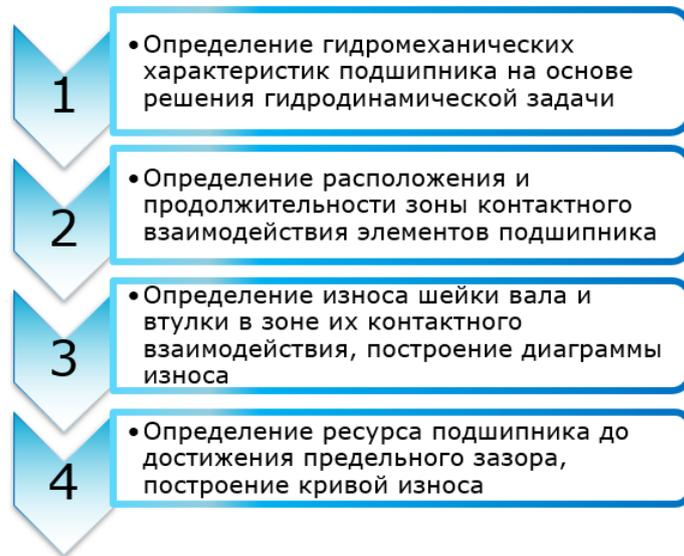
Рисунок 6 – Последовательность решения задач для определения износа и ресурса гидродинамических подшипников скольжения
