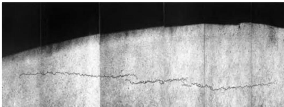
Рисунок 1.3 – Глубинное усталостное разрушение зуба (отслаивание упрочненного слоя) [13]
