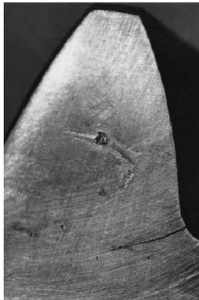
Рисунок 1.2 – Рост усталостной трещины в основании зуба [14]
