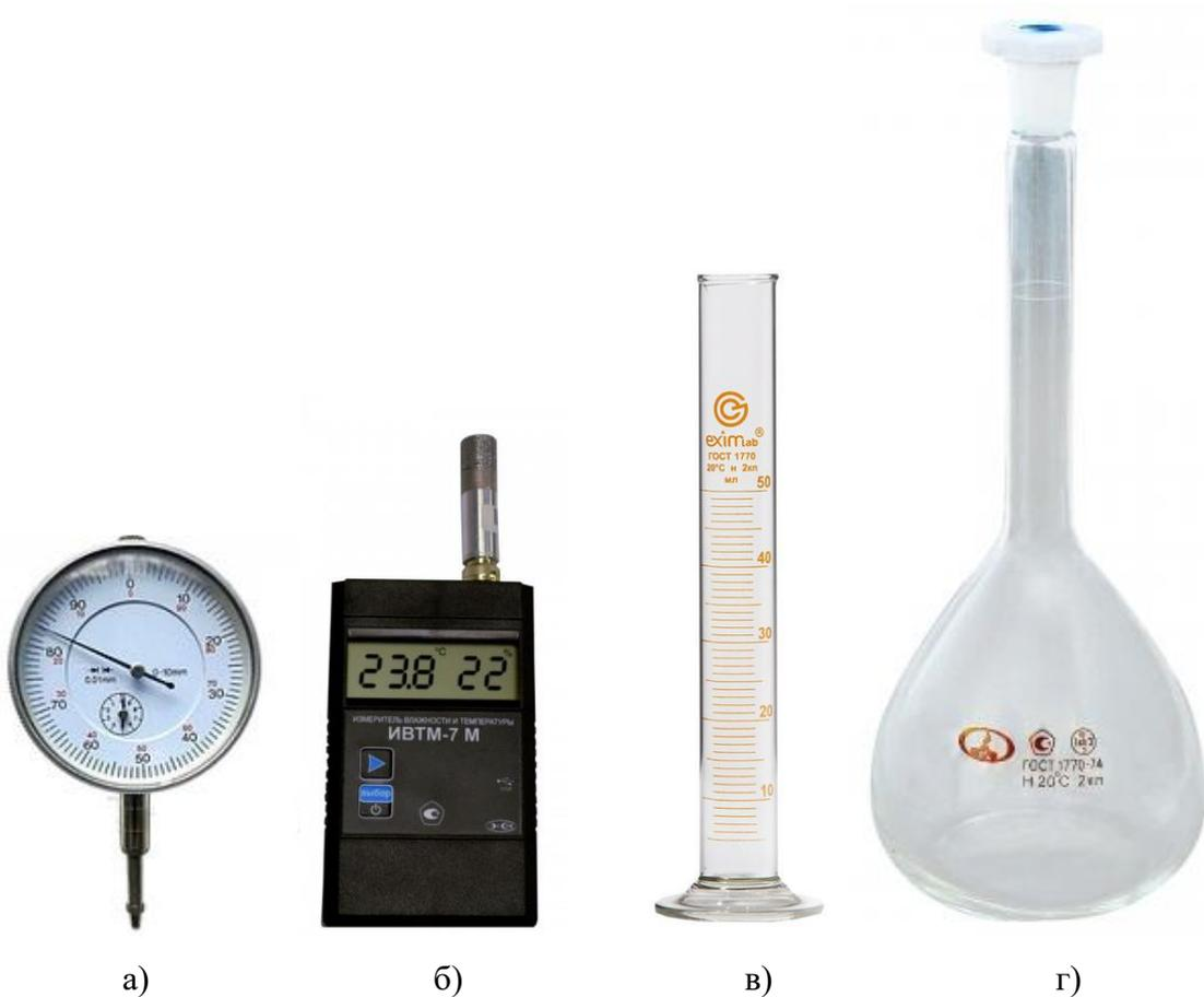
Рисунок 25 – Приборы и средства измерения испытательного стенда: а – индикатор часового типа ИЧ-10 ГОСТ 577 для микрометра; б – термогигрометр с функцией измерения атмосферного давления ИВТМ-7М 5Д; в, г – мерные емкости ГОСТ 1770 для калибровки емкости нагружения
