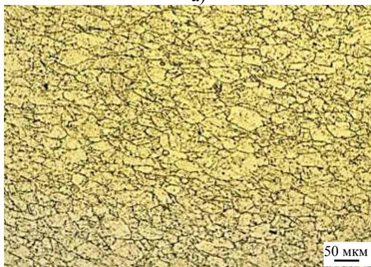
Рисунок 4.11 – Микроструктура стали марки 02X13H4M, пл.2 после закалки в масло от 1000 °C без VTMO (а) и после VTMO при 900 °C (б)
