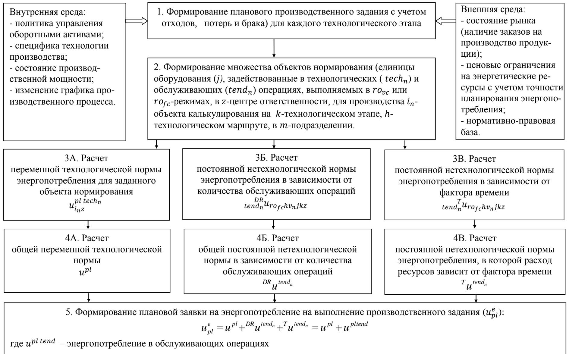
Рис. 7. Схема формирования нормативного энергопотребления, основанная на ТВС-модели управления затратами
