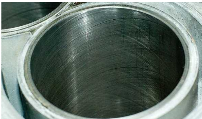
Рисунок 2.8 – Поверхность цилиндров после хонингования
