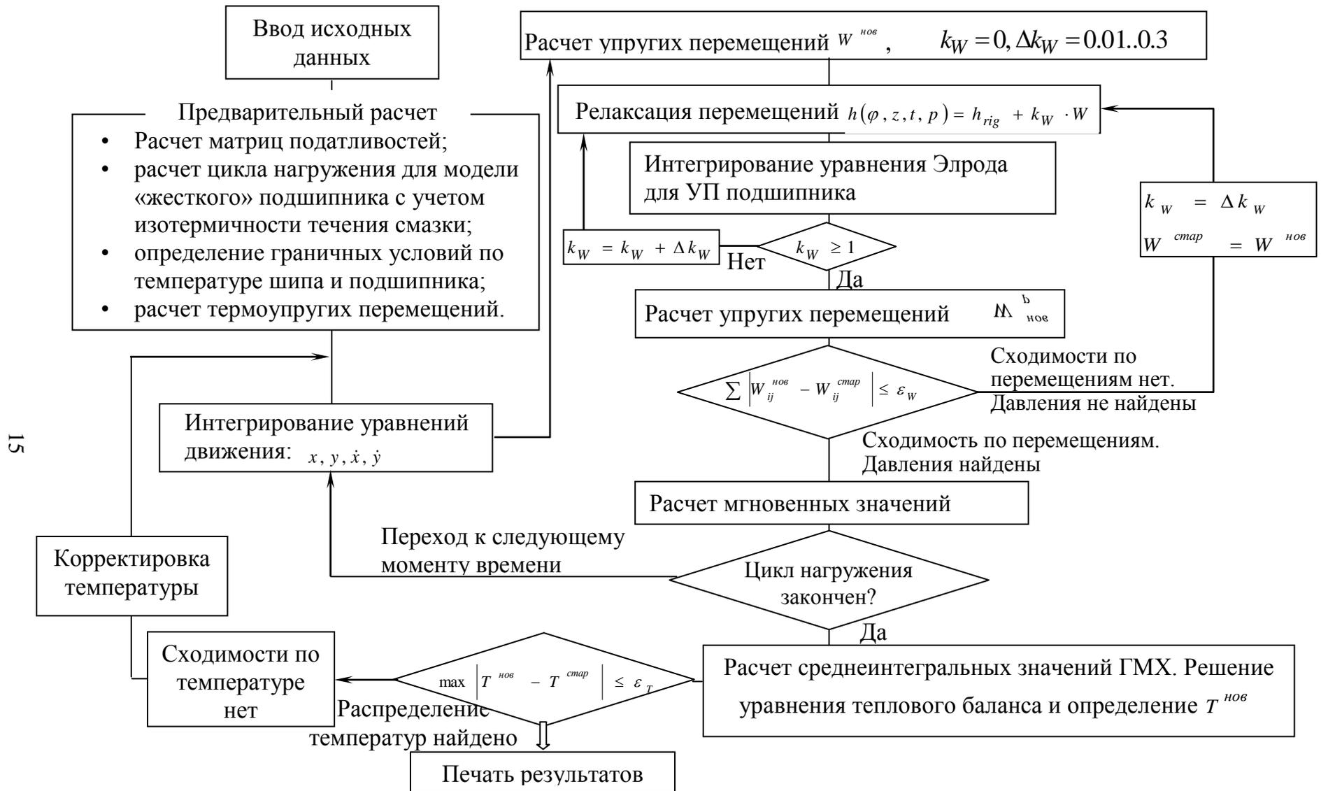
Рис. 2. Общая схема упругогидродинамического расчета подшипников скольжения
