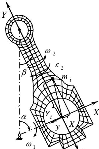
Рис. 1. К определению перемещений от инерционных нагрузок
