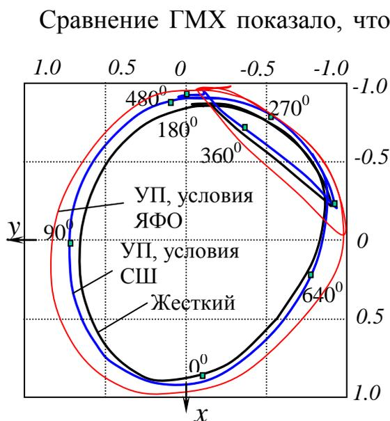
Рис. 4. Траектория движения центра шипа шатунного подшипника двигателя ЧН 21/21
