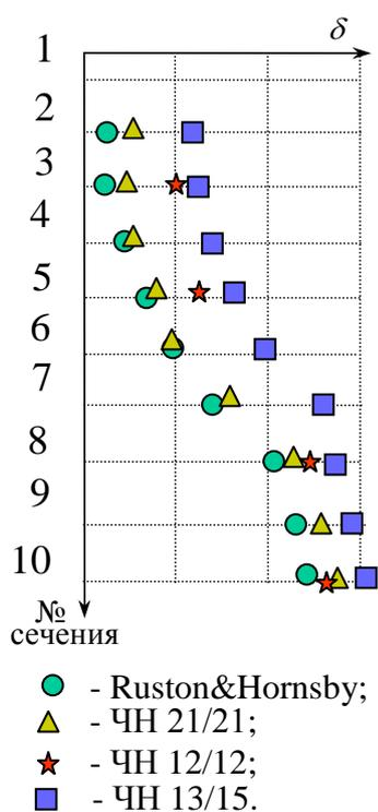
Рис. 5. К обоснованию расположения закрепления КЭ модели при решении задач УГД смазки шатунного подшипника
