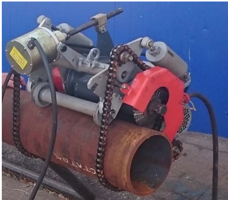
Рисунок 5.3 – Опытный образец машины для резки труб диаметром 315-2000 мм и толщиной стенки до 30 мм
