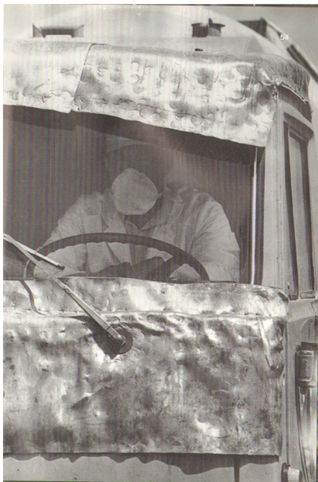
Рис. 1.8. Установка свинцовых листов на кабине грузового автомобиля
