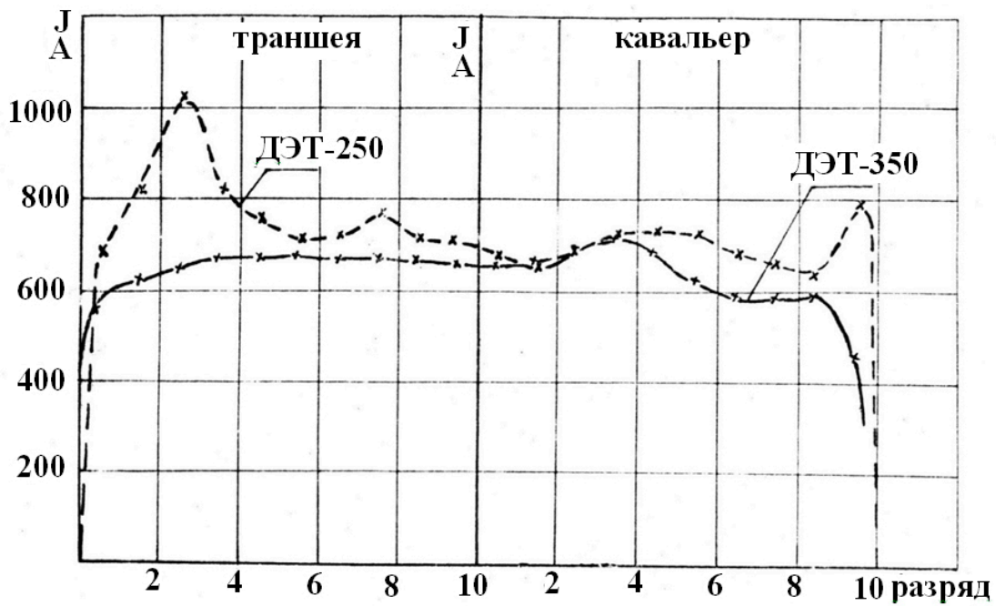
Рис. 5.11. Изменение силы тока бульдозеров ДЭТ-250М2 и ДЭТ-350 при разработке глинистого грунта III-IV категории по профилю траншеи и кавальера [140, 230]
