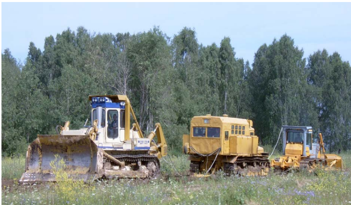
Рис. 5.6. Тяговые испытания трактора ДЭТ-350. Использование динамометрической лаборатории при тяговых испытаниях тракторов
