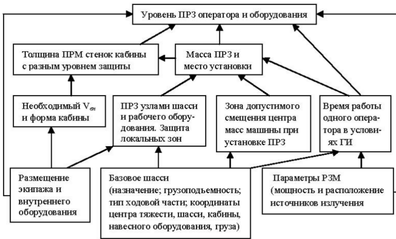
Рис. 3.9. Схема зависимости защиты экипажа стенками кабины от основных параметров машины и характеристик источника ГИ
