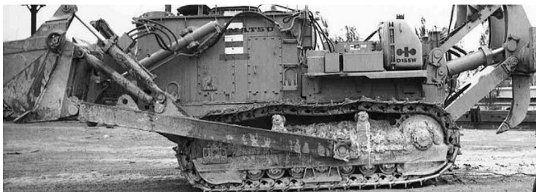
Рис. 1.12. Тяжелый мобильный робототехнический погрузчик на базе серийного гусеничного трактора «Комацу» (Япония).
