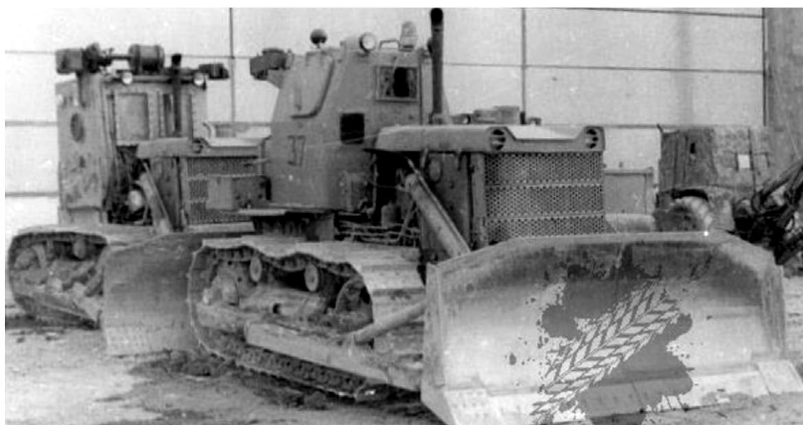
Рис. 1.7. Варианты бульдозеров с ПРЗ оператора на базе техники ЧТЗ, изготовленные серийно (ближний) и «кустарным способом» (дальний).
