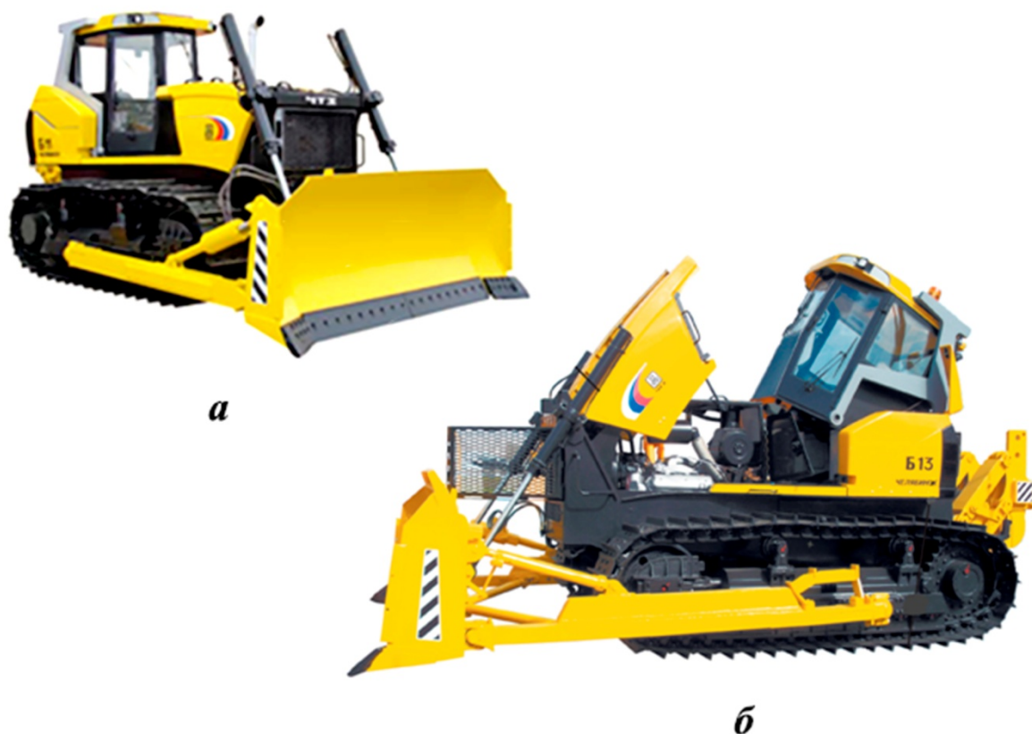
Рис.6.7. Некоторые конструктивные особенности бульдозеров на базе тракторов Т11(а) и Т13(б) производства ЧТЗ (откидываемая кабина в виде «капсулы», поворотные створки и лобовина капота для быстрого доступа к узлам трактора и др.). Патенты РФ № 65011, 68095, 92836 [173, 176, 180] и др.
