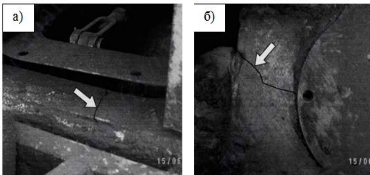
Рис. 6.5. Возникновение трещин в верхнем листе корпуса заднего моста рамы на некоторых бульдозерах Б10 (а), Б12 (б) (соответственно на базе тракторов Т10, Т12) после 3000...4500 моточасов работы.
