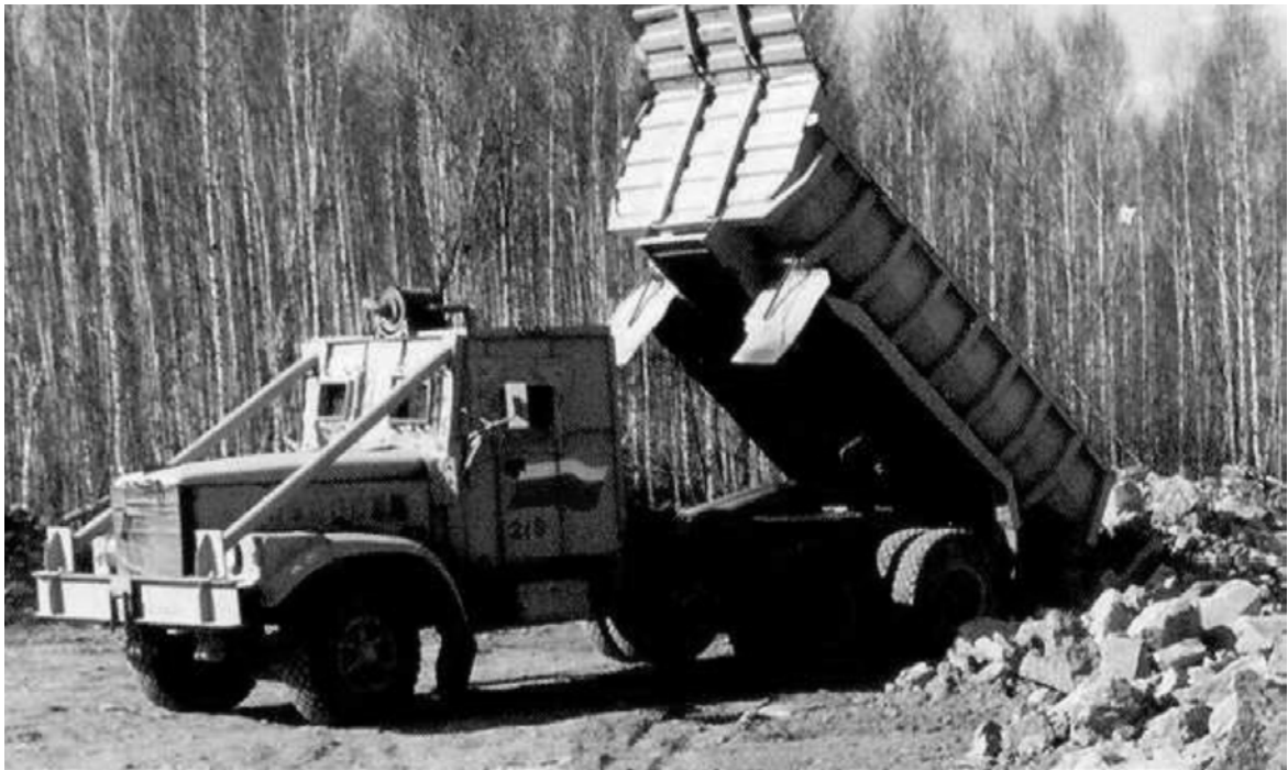
Рис. 1.4. Самосвал КрАЗ с ПРЗ на обваловке водоема (химический комбинат Маяк, Челябинская обл.)
