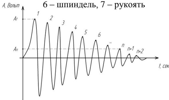
Рис.13 – Определение логарифмического декремента свободных затухающих колебаний
