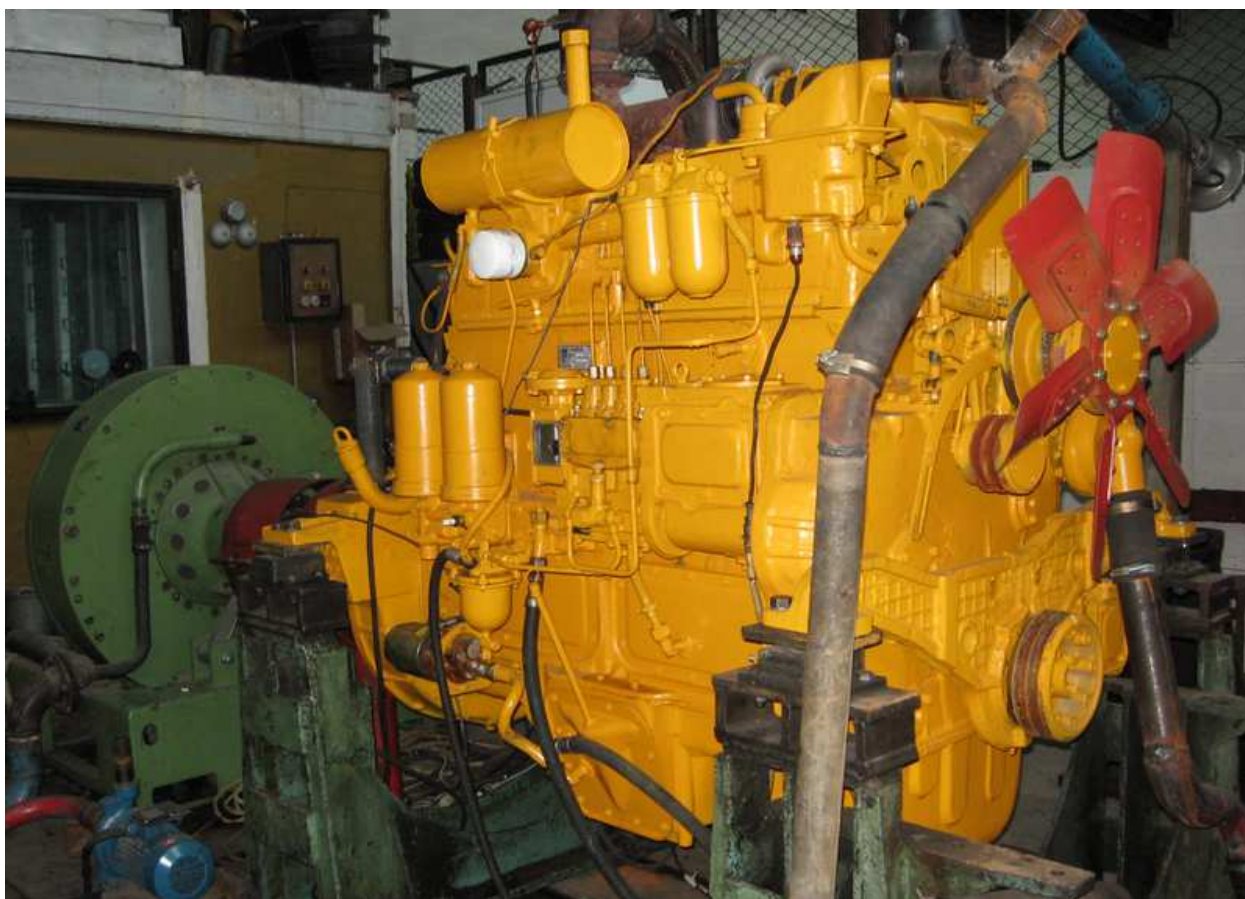
Рисунок 3.9 – Двигатель 4ЧН15/20.5 на испытательном стенде ОАО «НИИ АТТ»
