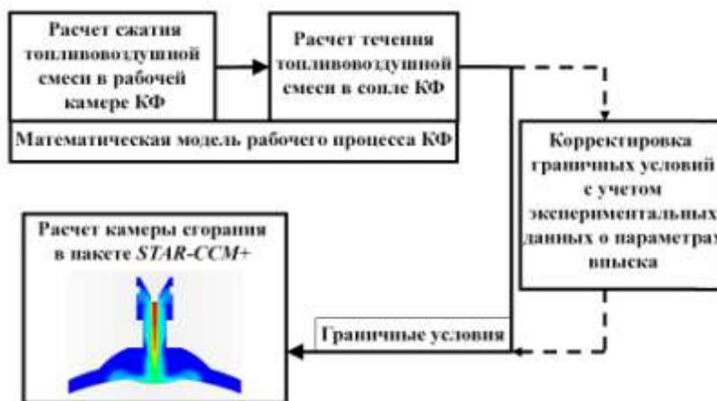
Рисунок 2 – Принципиальная схема методики моделирования процессов в КС экспериментального двигателя
