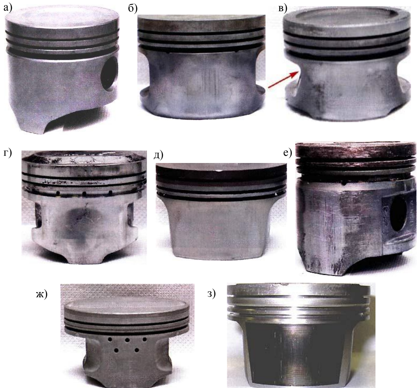
Рис. 1.1. Геометрия контакта юбки поршня с цилиндром
