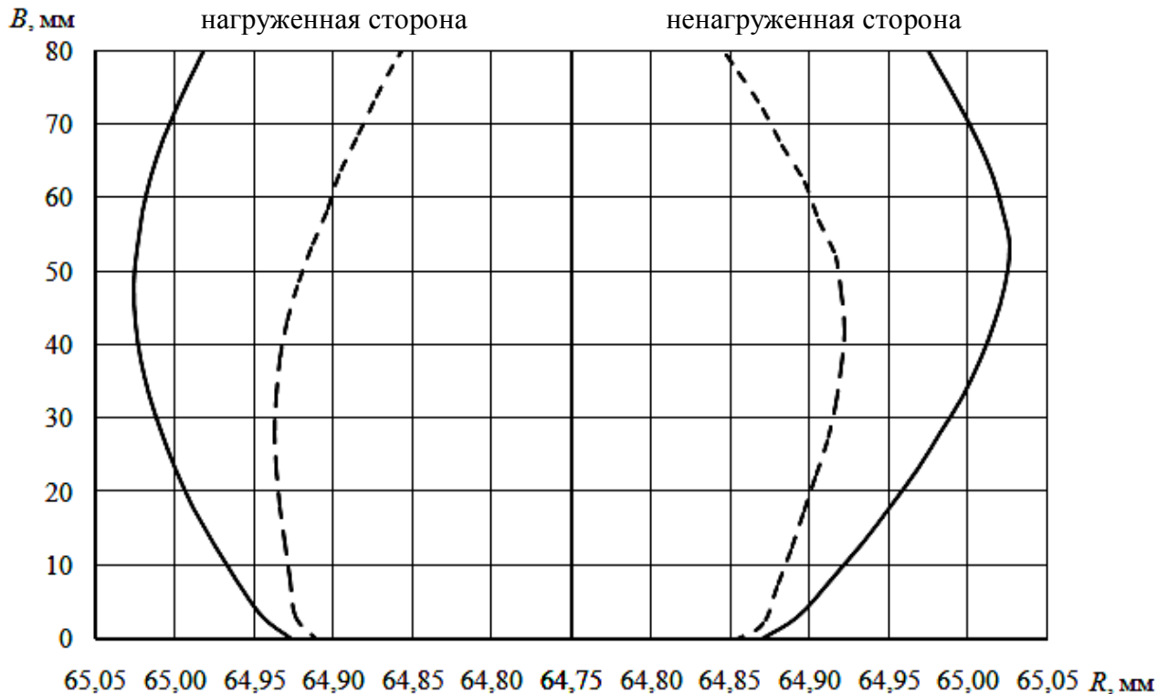
Рис. 4.3. Оптимизированный профиль юбки поршня:
