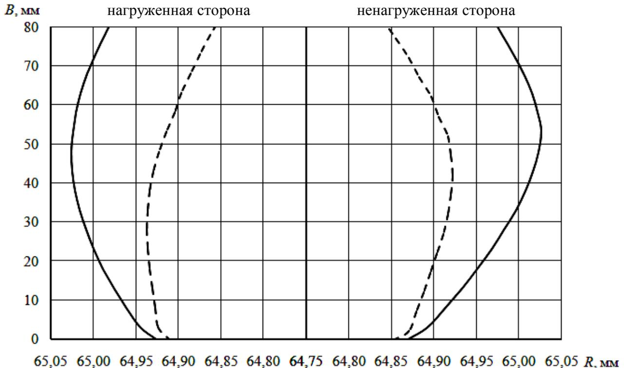
Рис. 4.3. Оптимизированный профиль юбки поршня:
