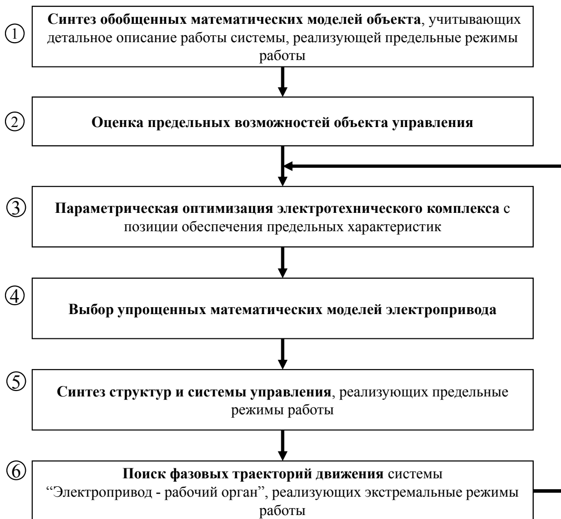
Рис. 1.9. Концепция синтеза электротехнических комплексов, реализующих предельные режимы работы
