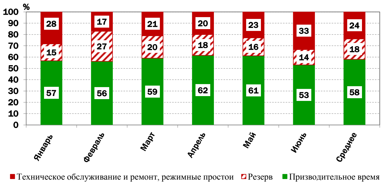
Рисунок 3.9 – Структура использования месячного фонда времени гидравлических экскаваторов: а) РС-3000№3, б) среднее, 2016 г. [135]
