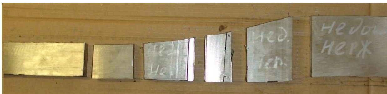
Рисунок 4.9. Фото поперечного сечения недоката после пилигримовой прокатки
