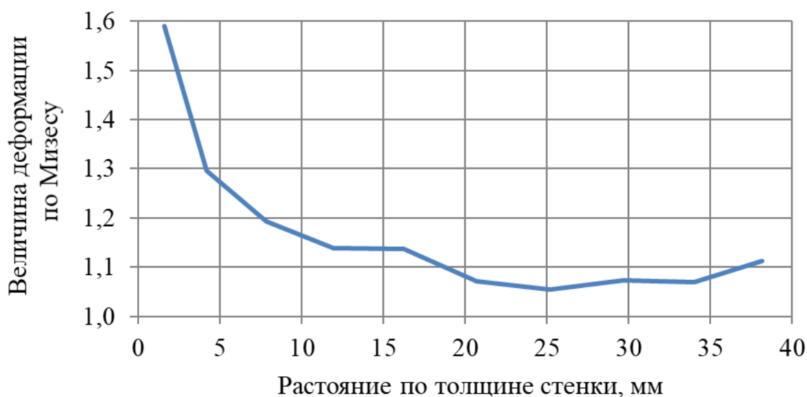
Рисунок 4.3. Распределение величины деформации по толщине стенки 0 мм – соответствует наружной поверхности; 40 мм – внутренней поверхности
