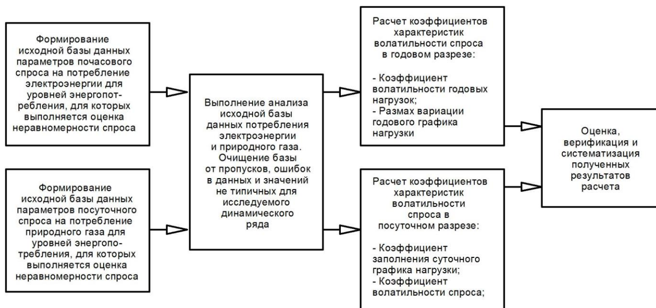
Рисунок 3.8 – Базовая структура метода оценки характеристик волатильности спроса на потребление электроэнергии и природного газа (разработано автором)
