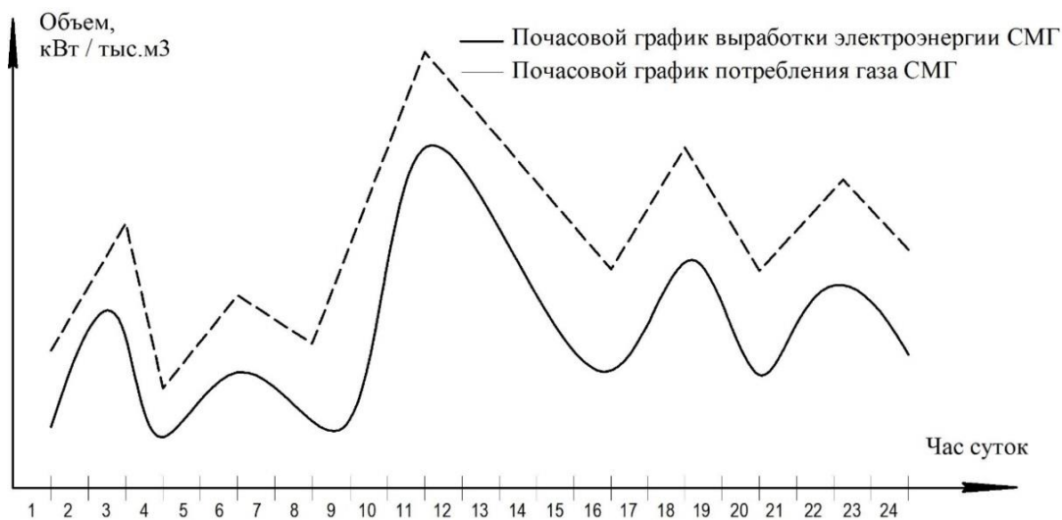
Рисунок 5.7 – Конфигурация графика выработки электроэнергии системой малой распределенной генерации и графика потребления природного газа на работу генераторов (разработано автором) [510]
