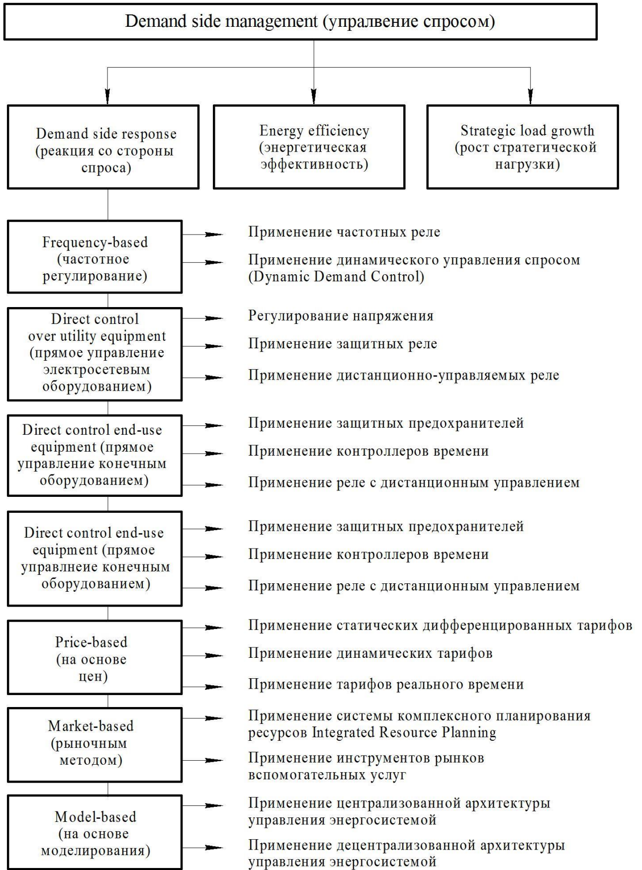
Рисунок 2.6 – Классификация направлений demand-side management и инструменты Demand-side response (систематизировано автором) [411]
