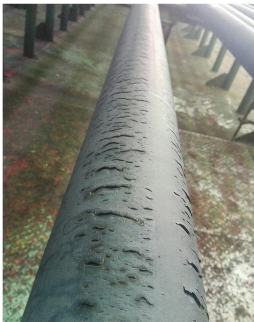
Рисунок 48 – Вид горячепрессованной трубы полученной с использованием штатной цилиндрической матрицы
