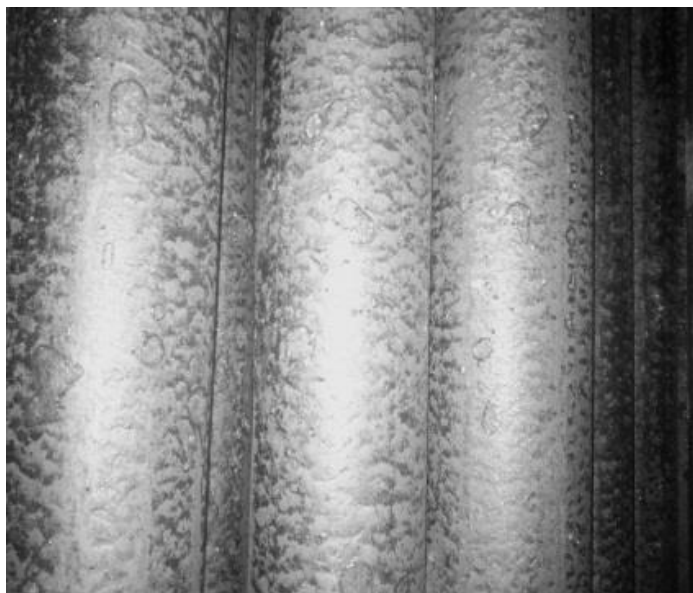
Рисунок 33 – Рябизна на наружной поверхности горячепрессованных труб из стали 12Х18Н10Т
