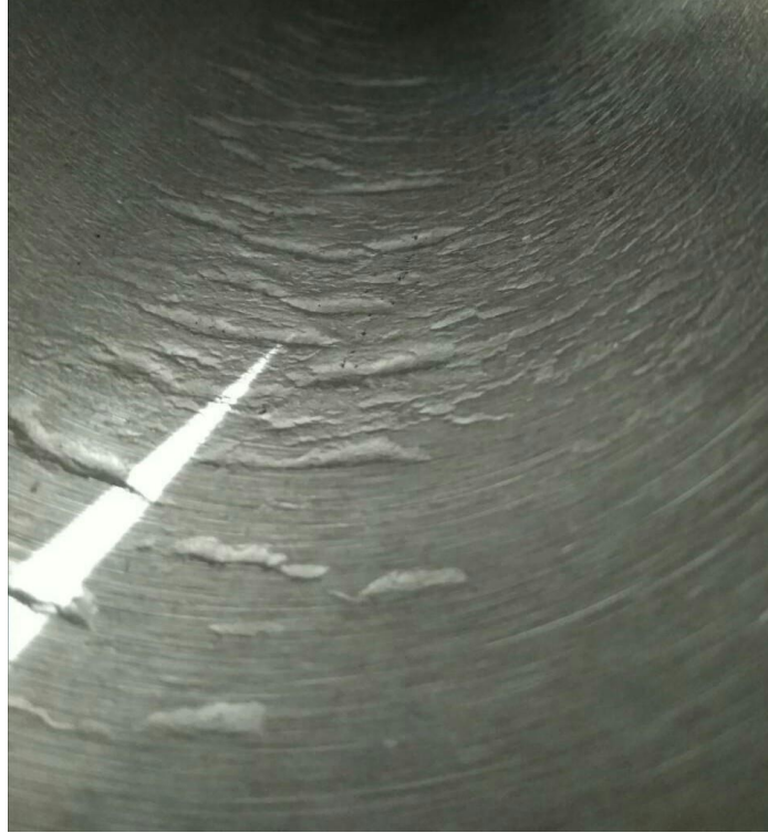
Рисунок П2.1. Внутренняя рябизна на трубах \varnothing 106 \times 6 мм из стали 08X18H10T
