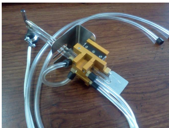
Рисунок 22 – Высокотемпературный датчик поперечной деформации (дилатометр)
