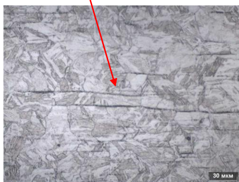
Рисунок 42 – Структура стали 08X13N4M1Ф-1 при температурах горячего прессования
