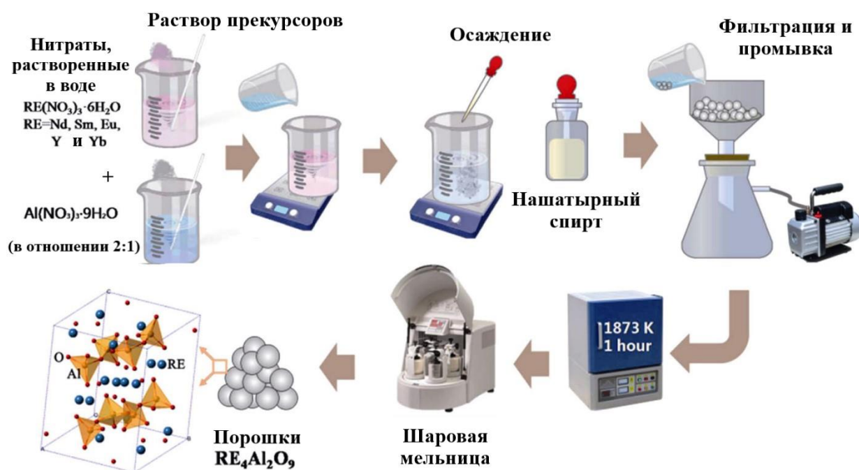
Рисунок 1.6 – Схематичное изображение процесса синтеза ВЭО (\text{Nd}_{0,2}\text{Sm}_{0,2}\text{Eu}_{0,2}\text{Y}_{0,2}\text{Yb}_{0,2})_4\text{Al}_2\text{O}_9 методом соосаждения [85]
