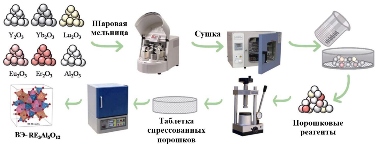
Рисунок 1.8 – Схематичное изображение получения ВЭО (Y_{0,2}Yb_{0,2}Lu_{0,2}Eu_{0,2}Er_{0,2})_3Al_5O_{12} методом твердофазного синтеза [90]
