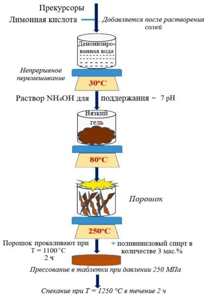
Рисунок 1.12 – Схематичное изображение процесса получения образцов допированных гексаферритов методом золь-гель синтеза согласно [148]
