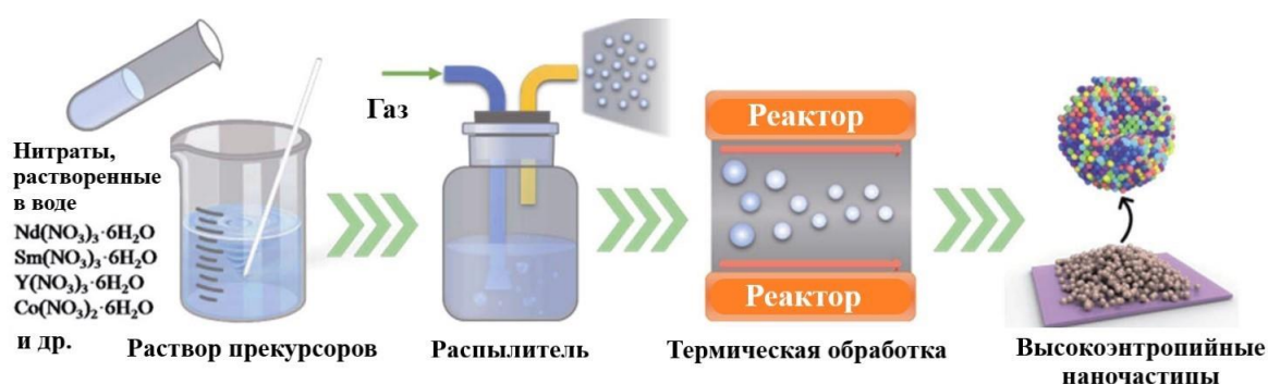
Рисунок 1.5 – Схематичное изображение синтеза высокоэнтропийных оксидов со структурой перовскита на основе редкоземельных и переходных металлов методом пиролиза аэрозолей [27]
