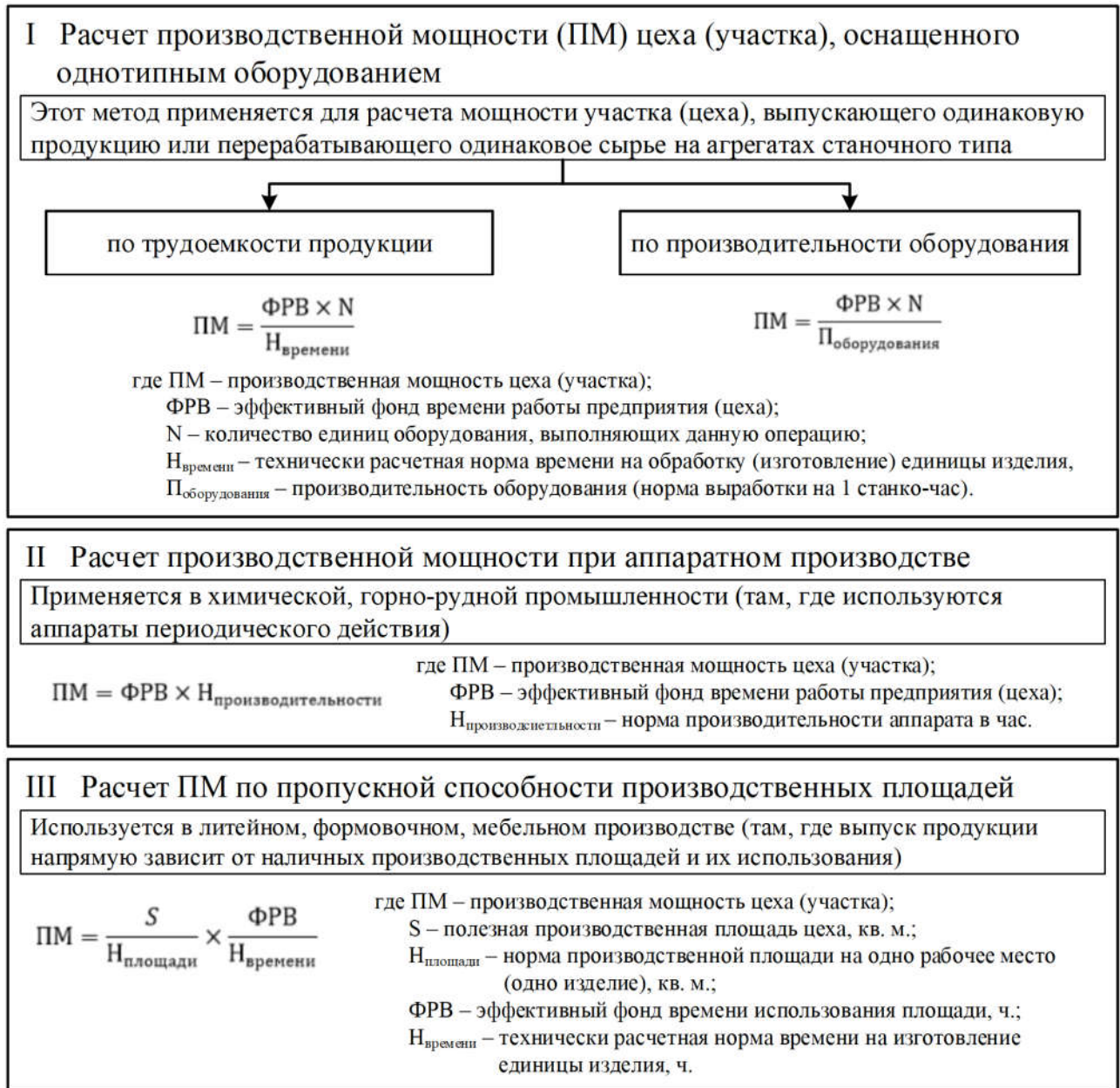
Рисунок 3.7 – Группировка существующих методов расчета производственных мощностей предприятия в зависимости от специфики производственного процесса (составлено автором)
