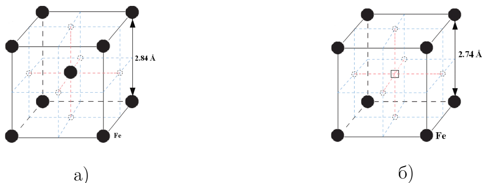
Рис. 3.7. Схематическое изображение изменения объема ячейки, образованной атомами Fe, которые являются первым окружением вакансии: а) без вакансии, б) с вакансией
