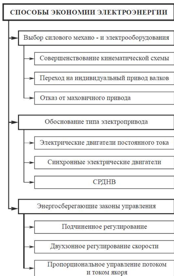
Рис. 1.9. Основные способы экономии электроэнергии в электроприводах пилигримовых станов
