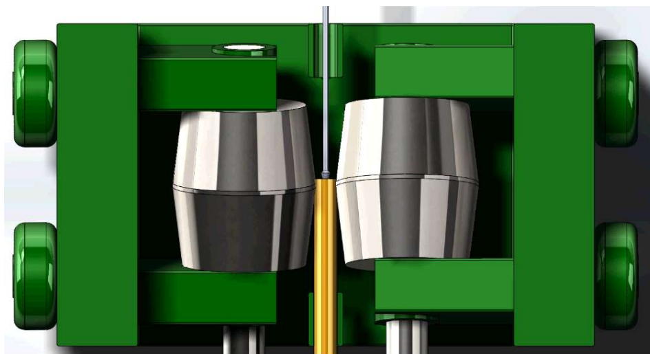
Рис. 1.1. Прокатка труб на прошивном стане
